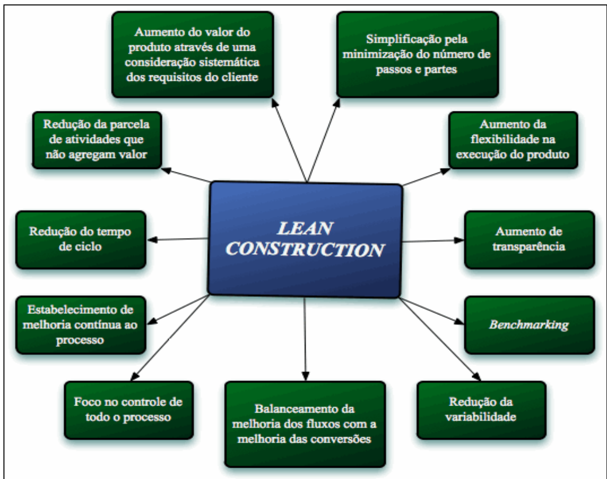
FIGURA 1 – Princípios básicos da filosofia Lean Construction Fonte: Com base em POZZOBON; HEINECK; FREITAS, 2004.
