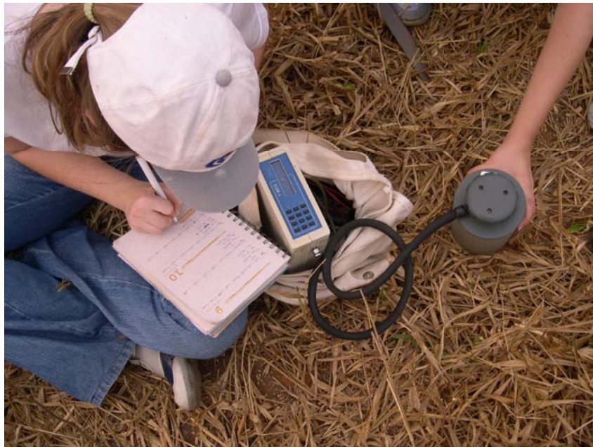
Figura 9 – Aparelho de medida de efluxo de CO 2 do solo, Modelo EGM/WMA-2 (PP System, Hitchin Hertz, UK).
