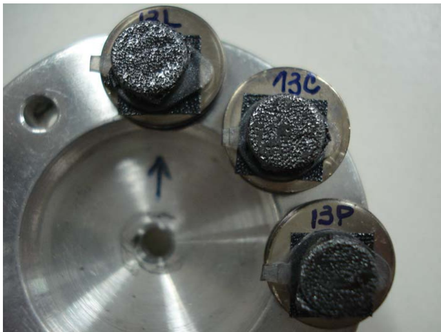
Figura 9. Amostras do material dissecado nas tampas dos tubos coletores após o preparo para o MEV (coating), apoiadas em placa de alumínio para a análise no microscópio de varredura
