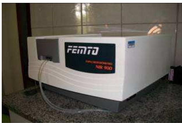
Figura 9. Espectrômetro de Infravermelho Próximo NIR 900.
