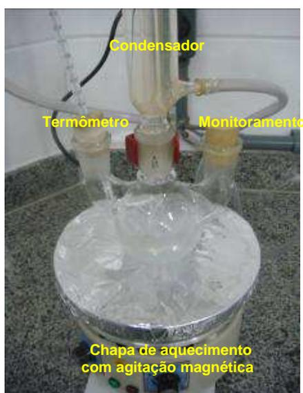
Figura 13. Reator usado para as reações de transesterificação.
