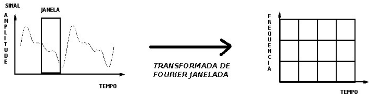
Figura 3.11 - A Transformada de Fourier Janelada mapeia um sinal em uma função bi-dimensional (tempo e frequência)
