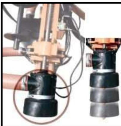
**Bocal Coletor de Pó:** O operador controla a saída do pó, abaixando ou levantando o bocal. Controlado dentro da cabina. Bastante utilizado no início da furação.
