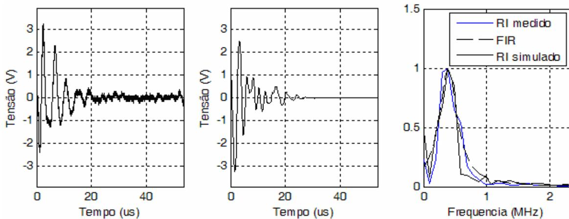
**Figura 4-13 : RI da classe “impulso único” com uma pseudofreqüência entre 0 e 1 MHz. (a) RI medido a ser simulado; (b) RI simulado; (c) Resposta em freqüência normalizada de ambos RI’s e filtro FIR.**
