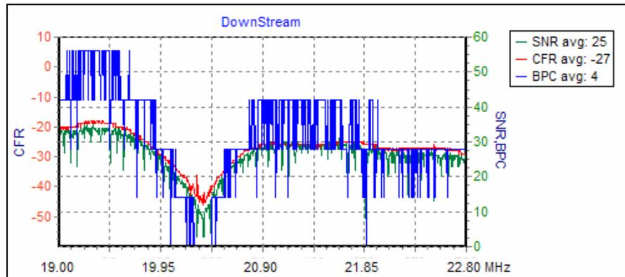
**Figura 1-2 : Modulação OFDM com aproximadamente 700 portadoras utilizando *bit loading*. O número de bits por portadora (BPC- *Bits Per Carrier*) (em azul) varia entre 0, 2, 4, 6 e 8 BPCs, de acordo com a SNR estimada (em verde). (Cortesia EBAPLC)**
