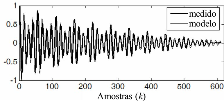
**Figura 3-3 : Autocorrelação do impulso medido e sua aproximação com o modelo da Equação (2.1) para estimar  $\beta$ .**
