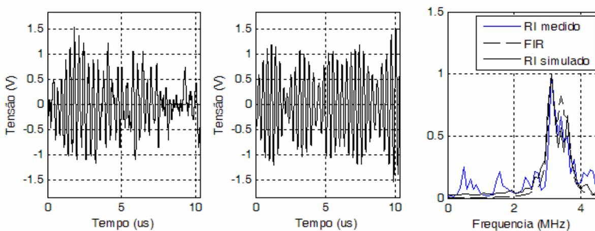
Figura 4-16 : RI da classe “explosão” com três pseudofreqüências entre 2 e 4 MHz. (a) RI medido a ser simulado; (b) RI simulado; (c) Resposta em freqüência normalizada de ambos RI’s e filtro FIR.
