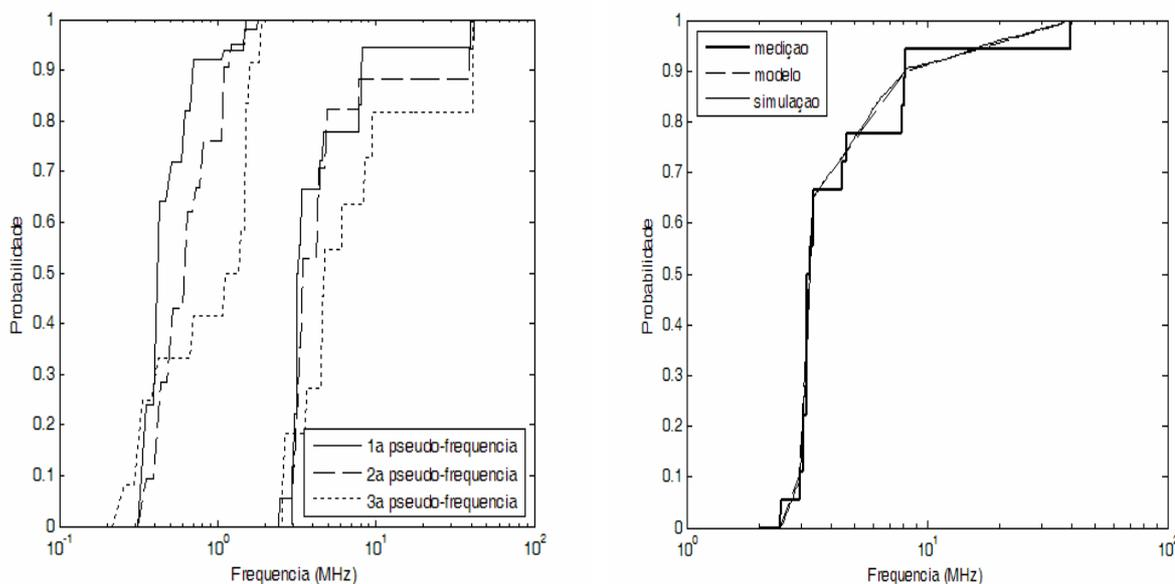
**Figura 3-16 : (a) Função de distribuição cumulativa das três pseudofreqüências, divididas para freqüências abaixo e acima de 2 MHz; (b) Função de distribuição cumulativa da pseudofreqüência de maior potência acima de MHz.**
