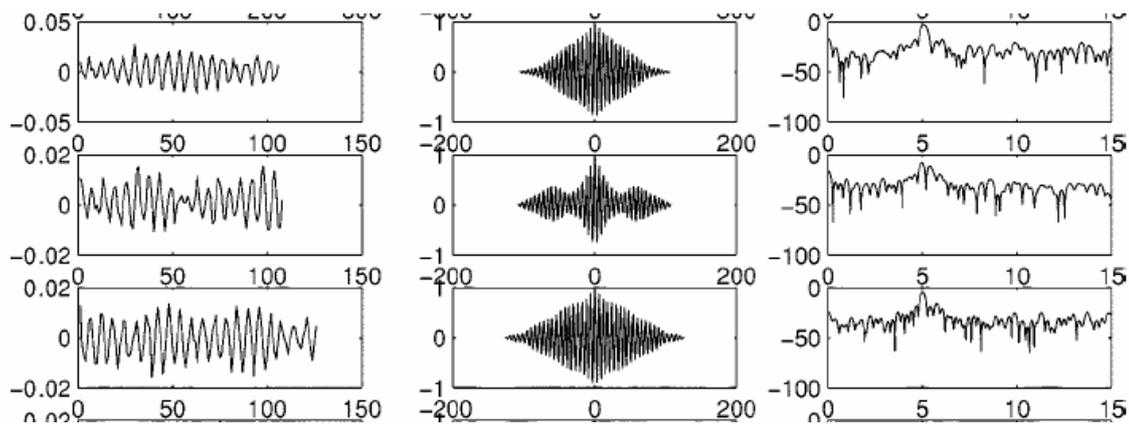
**Figura 2-11 :** Exemplos de ruídos impulsivos (à esquerda), sua autocorrelação (ao centro) e sua DEP. Os gráficos da esquerda mostram as amostras do RI por amplitude (V), os do centro mostram o atraso por correlação normalizada e os da direita mostram a DEP (dB) por frequência em MHz.
