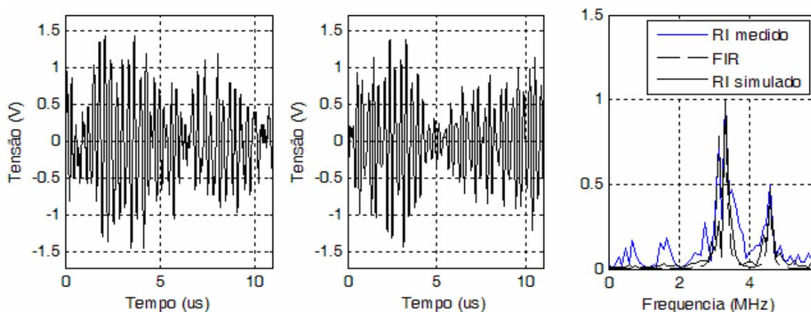
**Figura 4-14 : RI da classe “explosão” com três pseudofreqüências entre 2 e 5 MHz. (a) RI medido a ser simulado; (b) RI simulado; (c) Resposta em freqüência normalizada de ambos RI’s e filtro FIR.**
