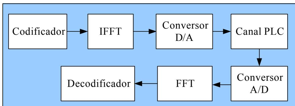
**Figura 1-1 : Diagrama de blocos simplificado da modulação OFDM**
