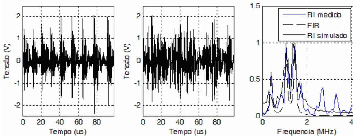
**Figura 4-17 : RI da classe “explosão” com três pseudofreqüências entre 0 e 2 MHz. (a) RI medido a ser simulado; (b) RI simulado; (c) Resposta em freqüência normalizada de ambos RI’s e filtro FIR.**
