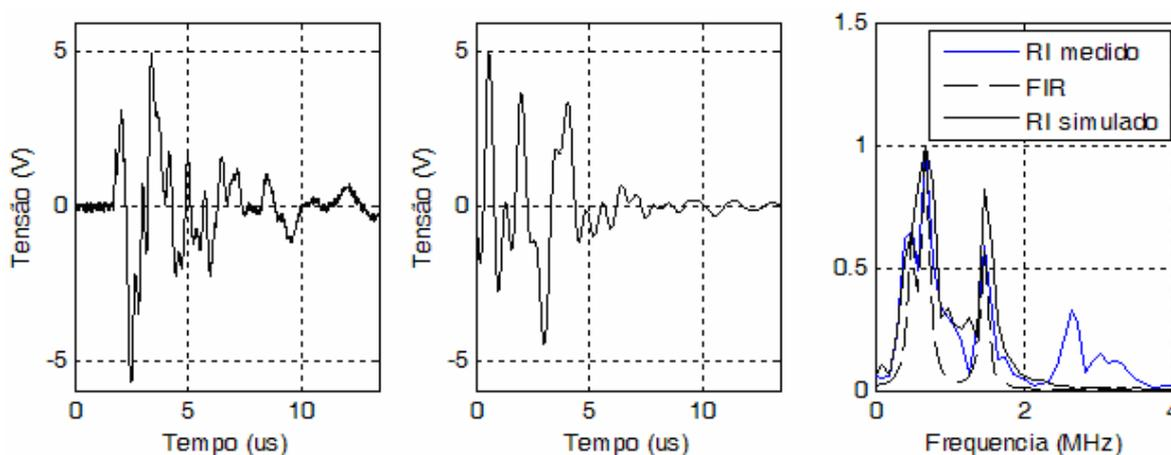
**Figura 4-12 : RI da classe “impulso único” com três pseudofreqüências entre 0 e 2 MHz. (a) RI medido a ser simulado; (b) RI simulado; (c) Resposta em frequência normalizada de ambos RI e filtro FIR.**
