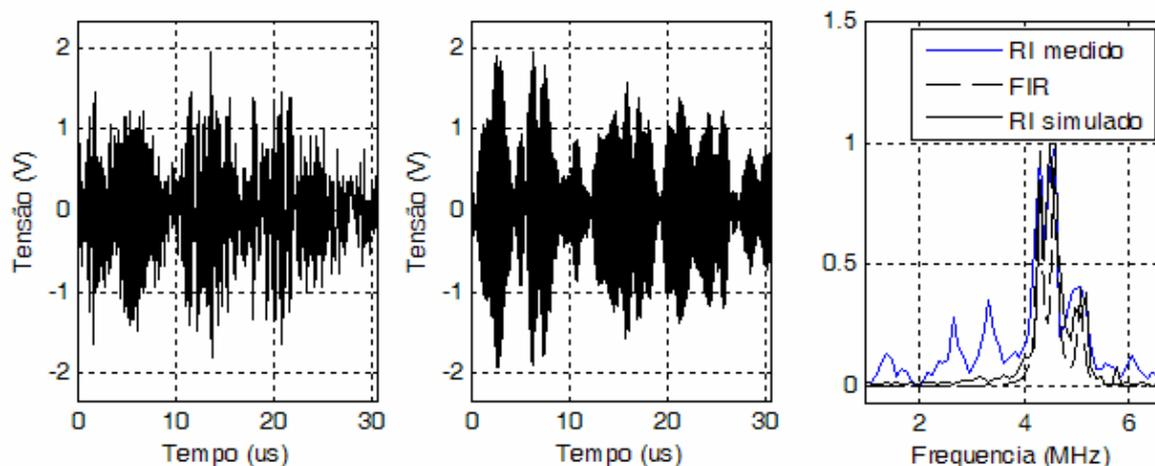
Figura 4-15 : RI da classe “explosão” com três pseudofreqüências entre 4 e 5 MHz. (a) RI medido a ser simulado; (b) RI simulado; (c) Resposta em freqüência normalizada de ambos RI’s e filtro FIR.
