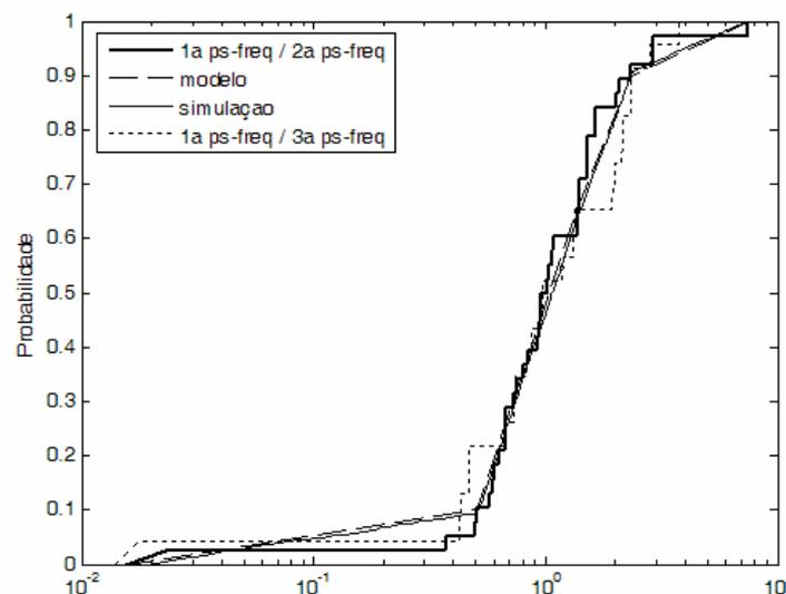
**Figura 3-17 : Função de distribuição cumulativa da relação entre as pseudofrequências  $\alpha_1/\alpha_2$  e  $\alpha_1/\alpha_3$  e modelo apenas para  $\alpha_1/\alpha_2$  (para frequências acima de 2 MHz).**
