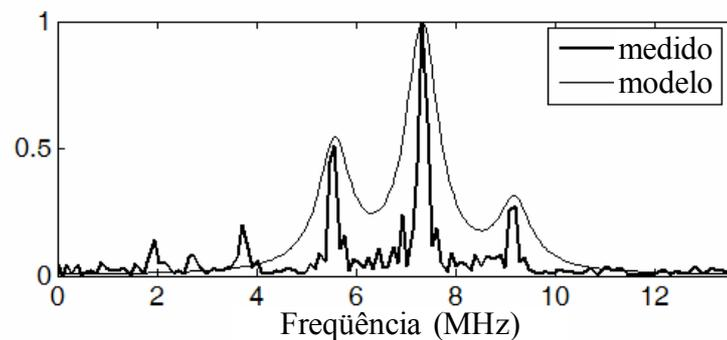
**Figura 3-4 : Espectro do RI medido e do espectro estimado  $\hat{X}(\omega)$  pelo modelo da Equação (2.5), utilizando o  $\beta$  estimado.**
