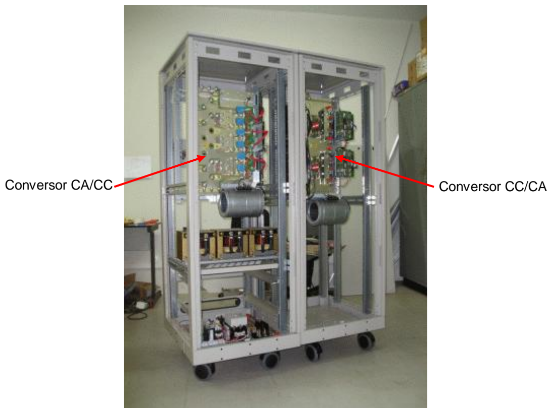
Figura 3.4 – Fonte RF de alimentação.
