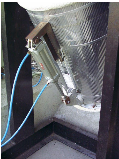
Figura 3.11 – Cilindro pneumático da porta de saída da escória vítrea.
