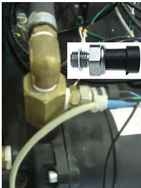
Figura 3.33 – Sensor de monitoramento das bombas.
