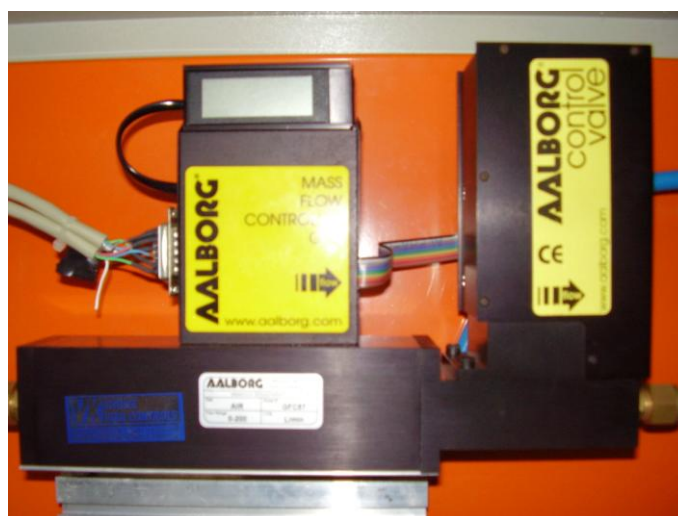
Figura 3.12 – Válvula de controle do gás plasmático – controlador de fluxo mássico.
