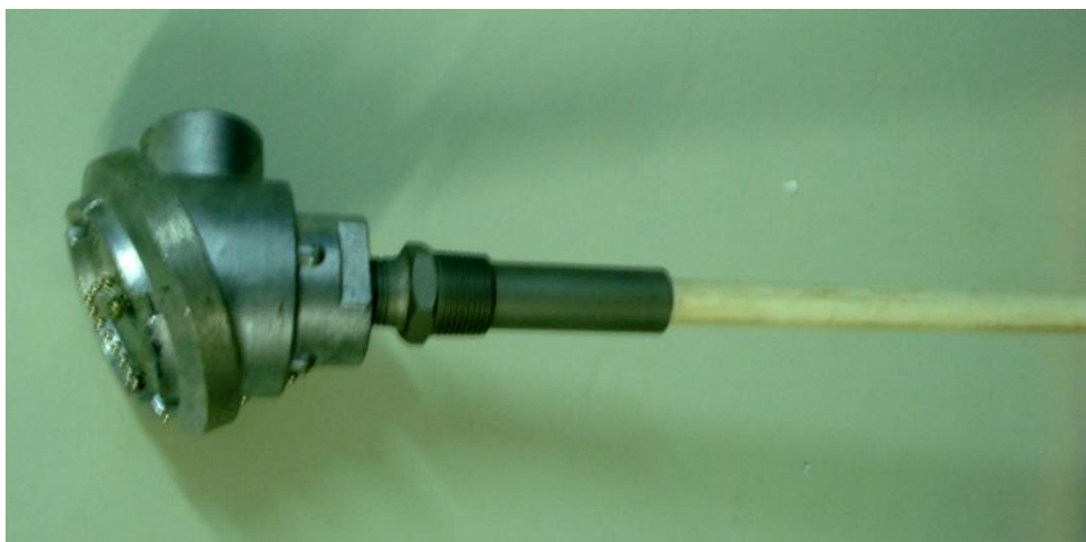
Figura 3.30 – Sensor de temperatura do reator principal.
