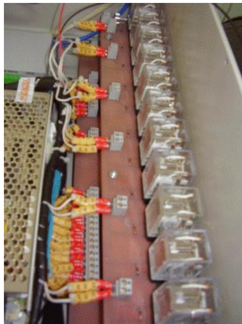
Figura 3.27 – Placa de interface de saídas digitais.
