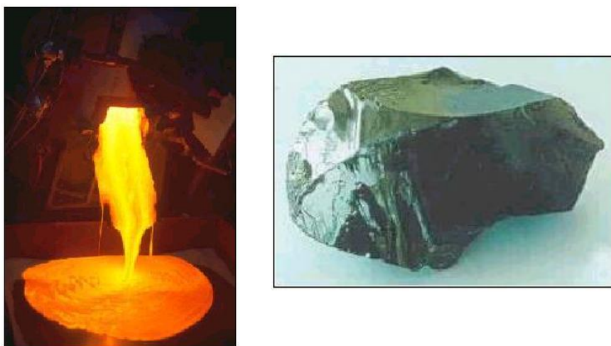
Figura 2.10 – Produto resultante da inertização da vitrificação dos resíduos.
