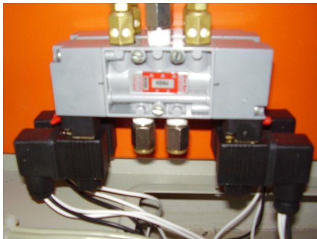
Figura 3.9 – Válvula utilizada para introdução de resíduos.
