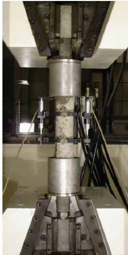
Ilustração 9 – Ensaio de resistência à tração direta (FURNAS-COPPE), para amostras cilíndricas (VELASCO, 2008).
