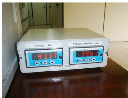
Ilustração 30 – Execução do ensaio do módulo de elasticidade: Equipamento de leitura digital e instrumentação do corpo-de-prova.
