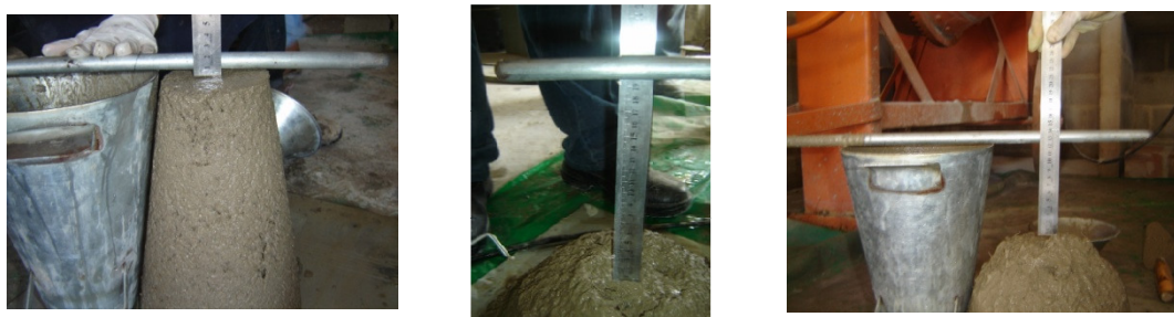
Ilustração 32 – Determinação dos abatimentos dos concretos CC, CREF-S/F e CRFA.
