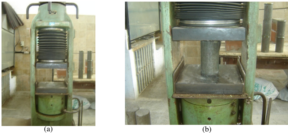
Ilustração 28 – (a) Prensa AMSLER de 200 tf; (b) Execução do ensaio de resistência à compressão
