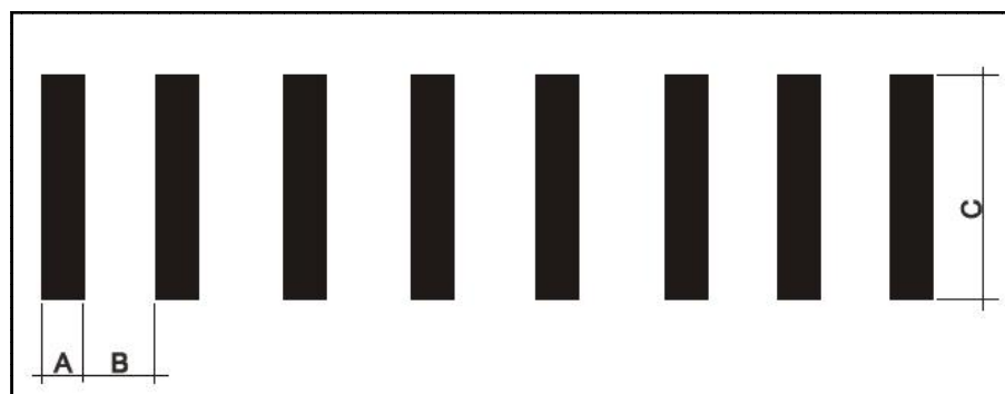
Figura 5.1 Faixa de Travessia de Pedestres
