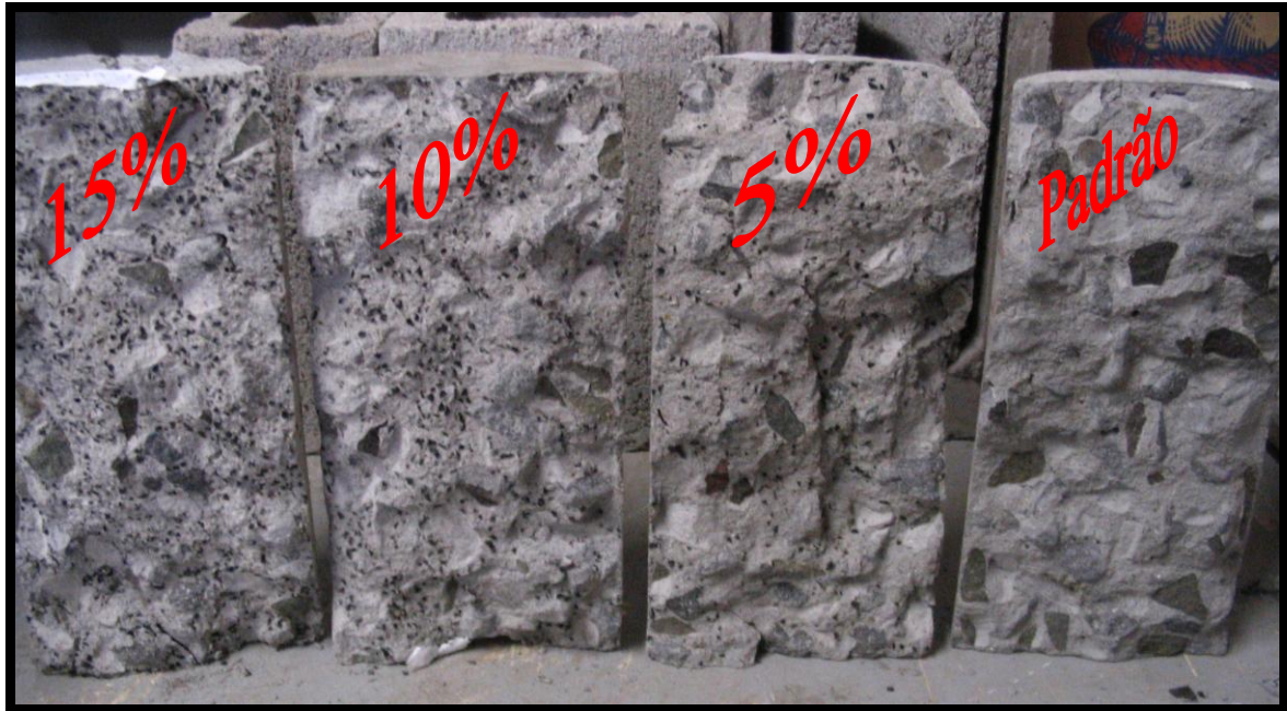
Figura 37: Aspecto interno dos corpos de prova C25
