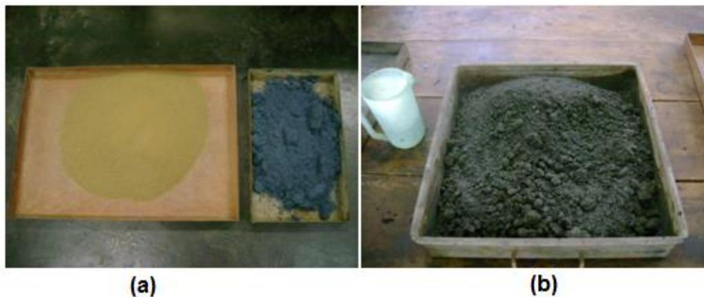
**Figura 3.4 – Processo de mistura de lodo e argila; (a) Argila cerâmica e lodo prontos para serem misturados e (b) mistura de lodo, argila e água**
