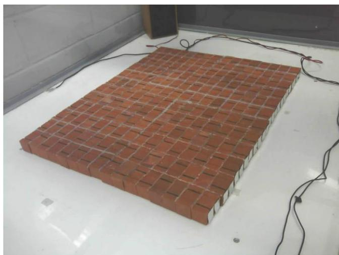
**Figura 4.12 – Painel de blocos cerâmicos acústicos com a vedação das laterais prontos para obtenção dos tempos de reverberação**
