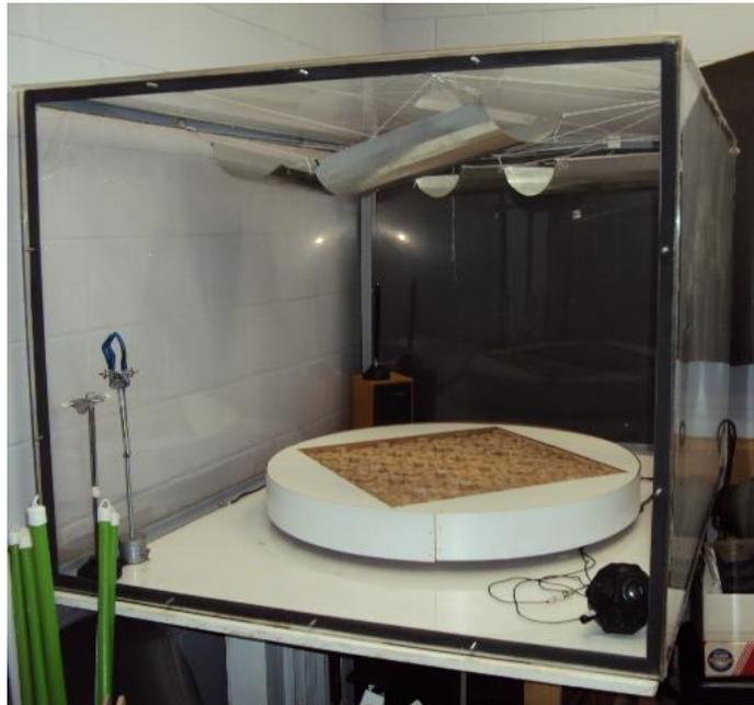
**Figura 4.10 – Câmara reverberante em escala reduzida 1:5**
