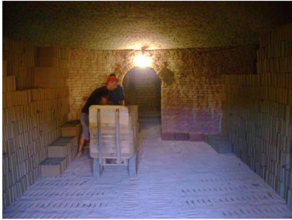
**Figura 3.8 – Forno da Indústria Cerâmica para queima dos blocos**
