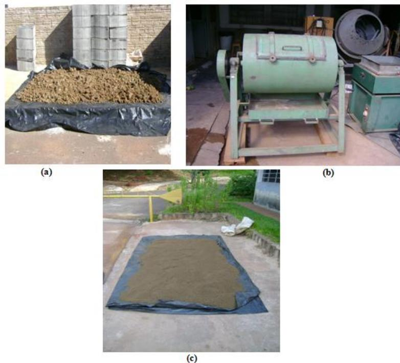
**Figura 3.3 – Etapas do beneficiamento da argila: (a) secagem, (b) destorroamento e (c) argila peneirada**
