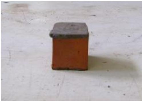
**Figura 3.13 – Bloco cerâmico capeado**
