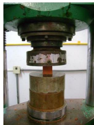
**Figura 3.15 – Ensaio de resistência à compressão do bloco cerâmico acústico em escala reduzida.**
