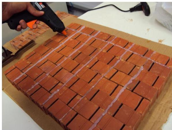
**Figura 4.11 – Montagem do painel de blocos cerâmicos acústicos com a vedação das juntas**
