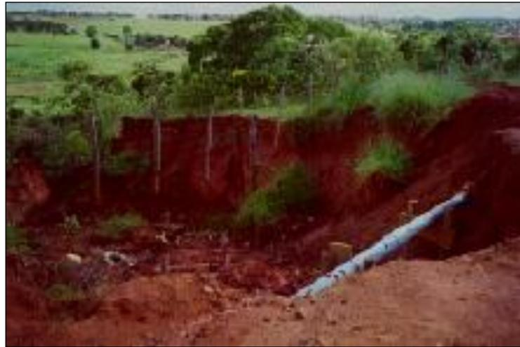
Figura 4 - Erosão tipo *piping*.
