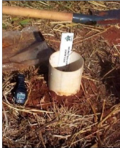
Figura 3: Cilindro único utilizado para verificar a infiltração de água no solo Fonte: Pereira (2009)
