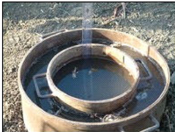
Figura 2: Cilindros concêntricos utilizados para verificar a infiltração de água no solo Fonte: Pereira (2009)
