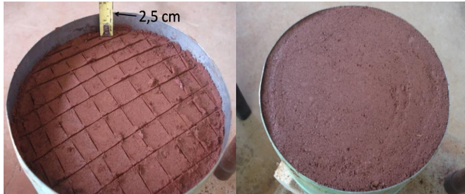
Figura 22: Compactação da camada 5 do corpo de prova.
