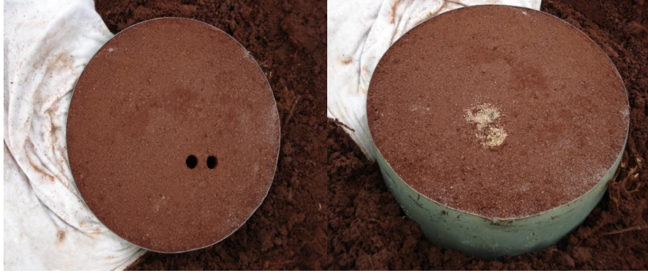
Figura 29: Preenchimento do solo com areia após remoção das amostras.
