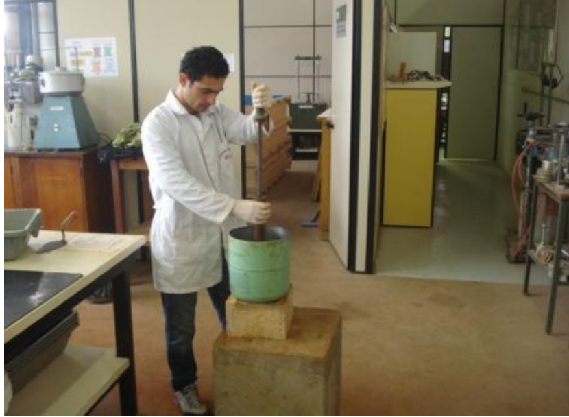
Figura 19: Moldagem do corpo de prova.
