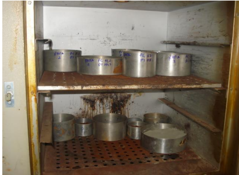
Figura 12: Secagem das amostras para determinação da umidade.
