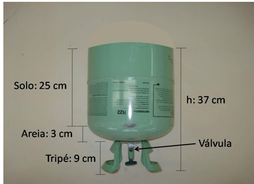
Figura 13: Modelo de biorreator utilizado na pesquisa.
