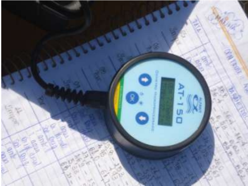
FIGURA 5 - Oxímetro digital utilizado para monitorar o oxigênio dissolvido e registro dos dados coletados sobre a água
