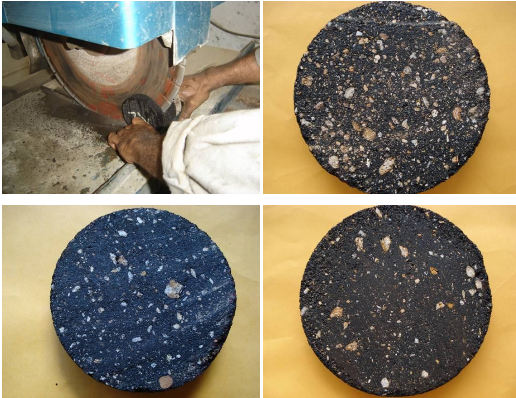
Figura 5.26: Ilustração da serragem de corpos de prova de AAUF com areia dos rios Aracatiaçu, Aracoiaba e Jaguaribe (Fotos do autor)
