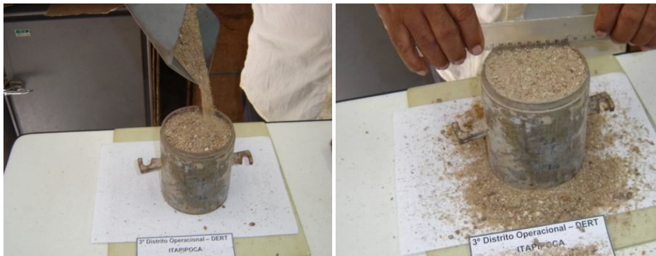
Figura 5.15: Ensaio de massa específica aparente dos agregados, em estado solto.
