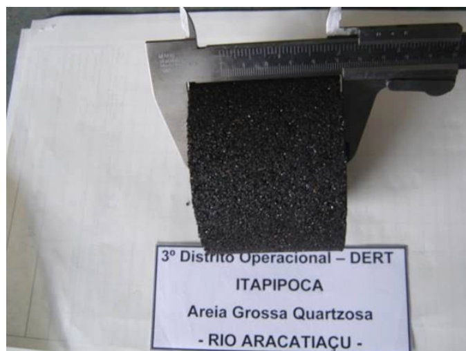
Figura 5.36: Corpo de prova de areia grossa asfáltica a quente com espessura dentro dos limites fixados (Foto do autor).
