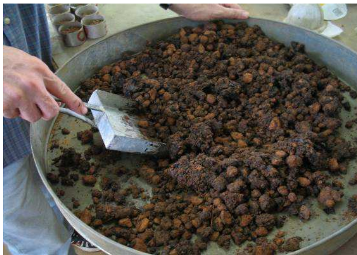
Figura 2.38: Dificuldade na homogeneização da mistura do cascalho laterítico com emulsão (SANT'ANA, 2009).
