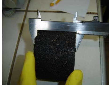
Figura 5.40: Medição de CP de areia asfáltica a frio com RL-1C (Foto do autor).
