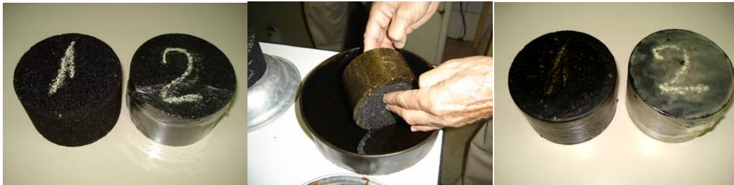
Figura 5.49: Corpos de prova parafinados sem e com filme de PVC (Fotos do autor).
