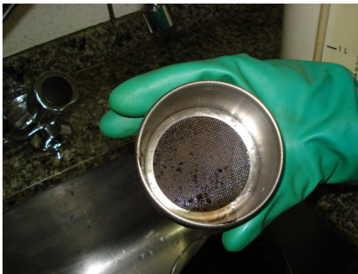
Figura 2.72: “Pelotas” de asfalto retidos na peneira (Foto do autor).
