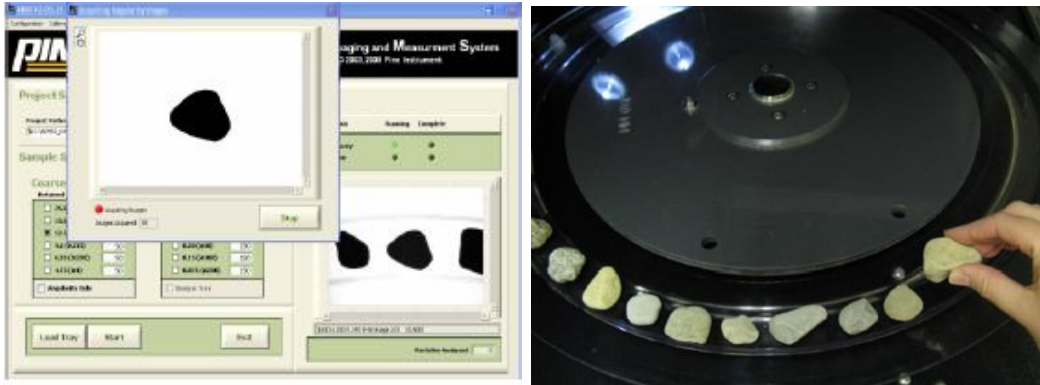
Figura 2.99: Ilustração da captura da imagem das partículas graúdas e o seu posicionamento na bandeja (PINE INSTRUMENT COMPANY, 2010).
