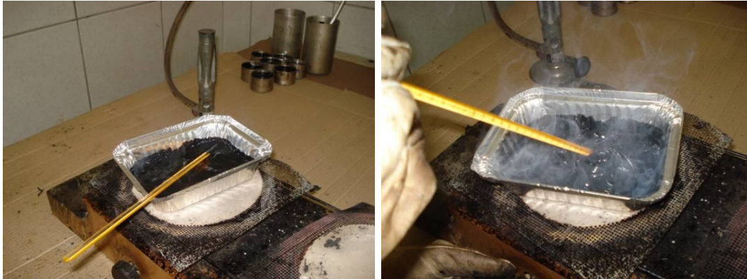
Figura 2.69: Ensaio de determinação do resíduo por evaporação (Fotos do autor).
