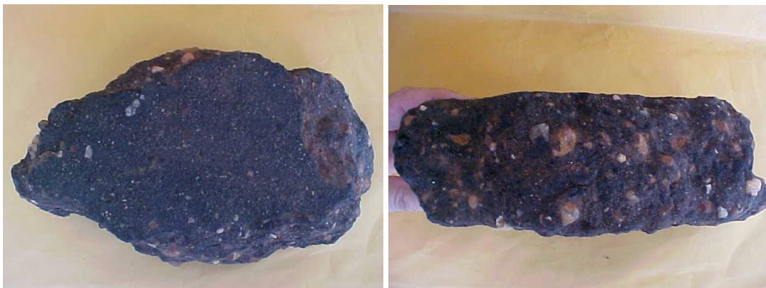
Figura 2.34: Amostra de solo-betume do trecho Belém – Icapuí (Ceará), removido em 1989 (Fotos do autor).
