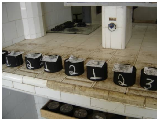
Figura 5.34: Corpos de prova de areia grossa asfáltica a quente, moldados por compactação Marshall manual (Foto do autor).
