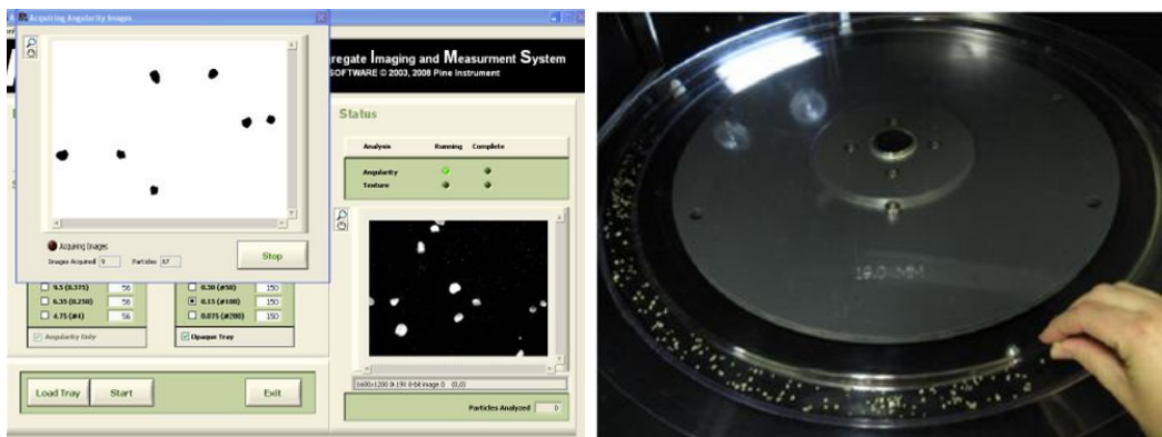
Figura 2.101: Ilustração da captura da imagem dos agregados miúdos distribuídos uniformemente na bandeja (PINE INSTRUMENT COMPANY, 2010).
