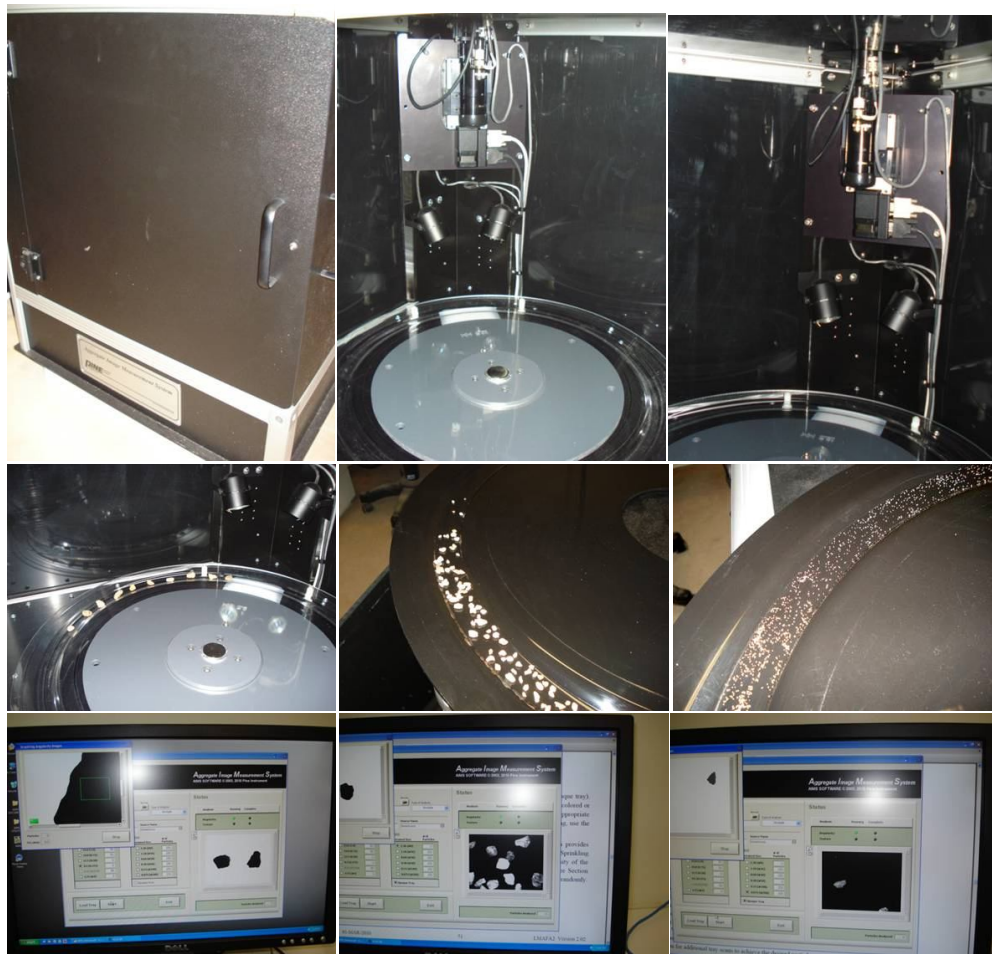
Figura 6.1: Imagens do ensaio AIMS no Laboratório do LMP/UFC (Fotos do autor).
