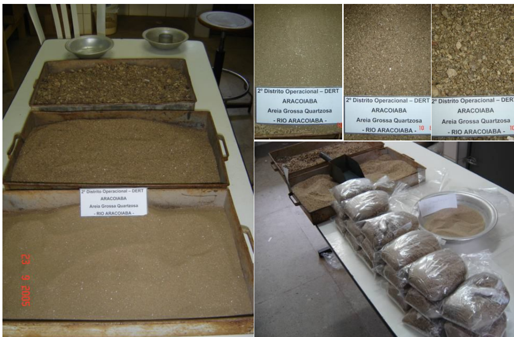
Figura 5.33: Amostra do rio Aracoiaba fracionada em três faixas de peneiras (grossa: #3/8” – #nº 10, média: #nº 10 – #nº 40 e fina: passando na #nº 40) (Fotos do autor).
