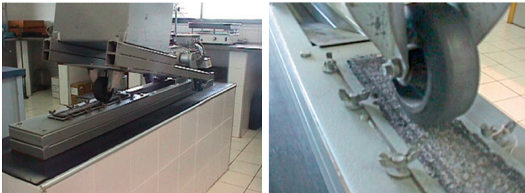
Figura 2.91: Aparelho para ensaio de LWT e no detalhe da roda (BERNUCCI et al. , 2007).
