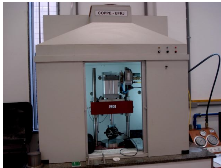
Figura 2.84: Equipamento automatizado para realização de ensaio de módulo de resiliência pertencente ao Laboratório de Geotecnia da COPPE/UFRJ (Foto do autor).
