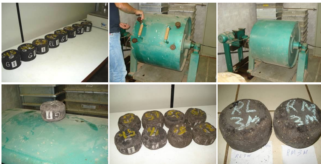
Figura 6.18: Fotos do ensaio Cântabro no Laboratório de Geotecnia da COPPE/UFRJ (Fotos do autor).
