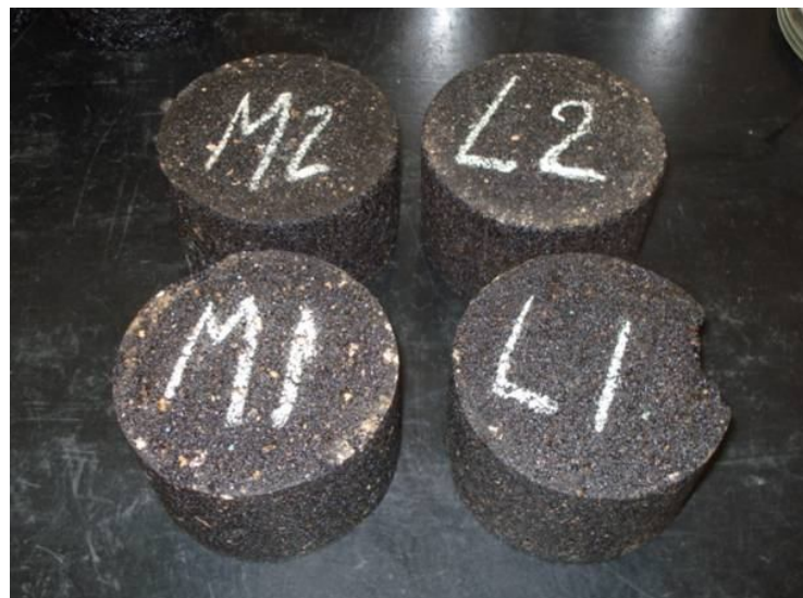
Figura 6.9: Corpos de prova usados para ensaios de tomografia computadorizada em laboratório do CENPES/PETROBRAS.
