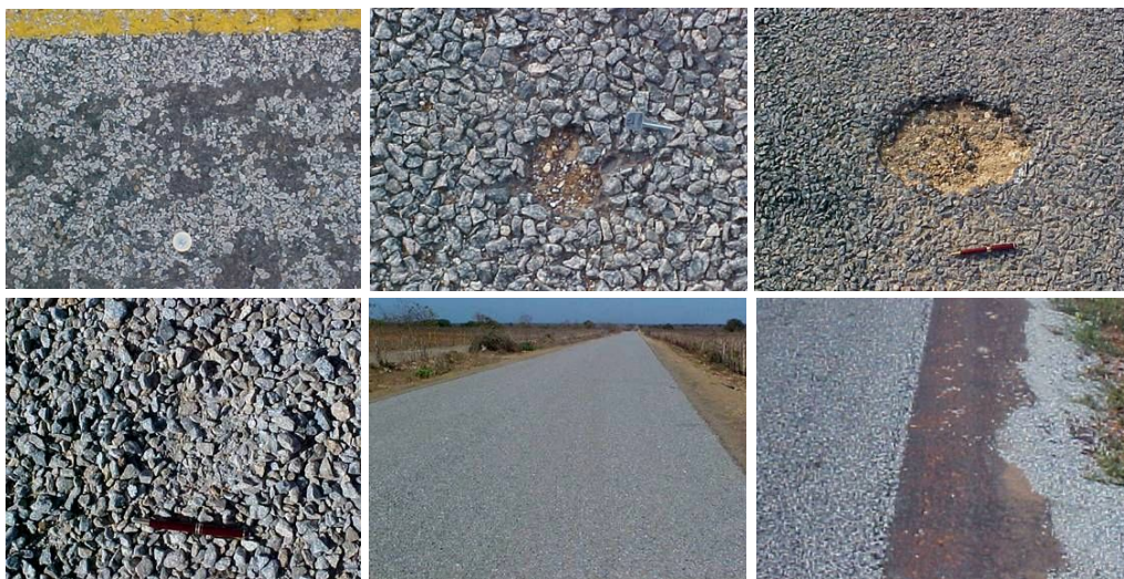
Figura 2.44: Ilustração dos problemas que podem ocorrer nos TS por falta ou excesso de agregados (Fotos do Autor).
