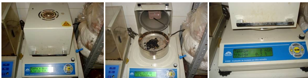
Figura 5.60: Analisador de Umidade por Infravermelho equipamento do LMP/UFC, que fornece com rapidez a umidade presente nas misturas (Fotos do autor).
