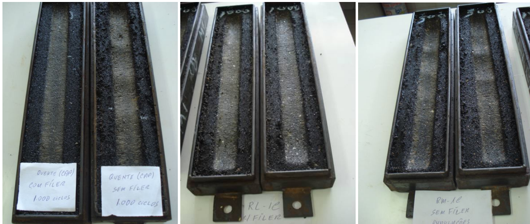
Figura 6.28: Corpos de prova de mistura a quente e a frio após ensaios no LWT (Fotos do autor).
