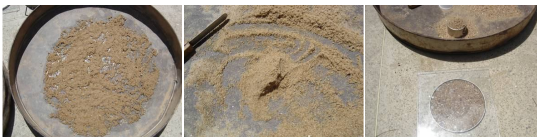
Figura 5.17: Sequência do procedimento proposto para secagem da superfície do grão (Fotos do autor).
