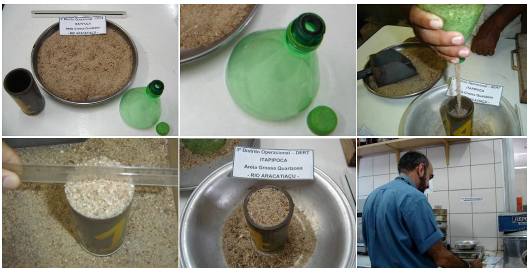
Figura 5.16: Procedimento de ensaio modificado para determinação do peso do agregado.
