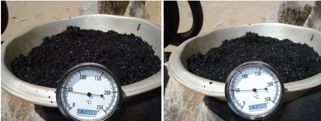
Figura 5.52: Misturas asfálticas a frio com RL-1C expostas ao sol para determinação da temperatura e perda de umidade (Fotos do autor).
