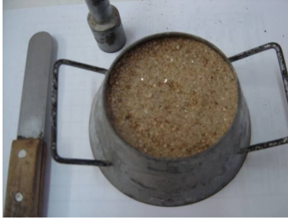
Figura 5.18: Ensaio de grãos superficialmente seco (Foto do autor).
