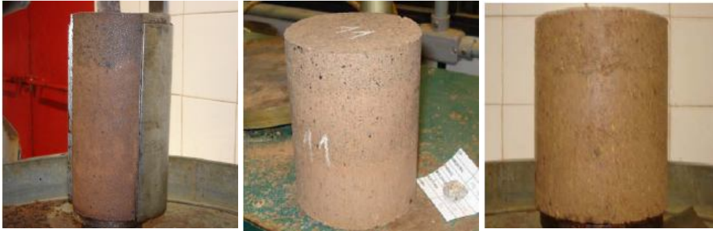
Figura 2.41: Detalhe dos CPs dos três solos estabilizados com distribuição de emulsão em gradiente utilizados na pesquisa (GONDIM, 2008).
