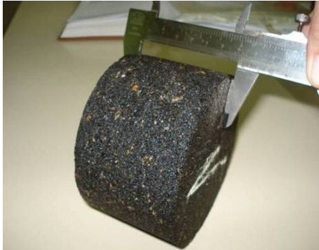
Figura 5.39: Medição de CP de areia asfáltica a frio com RM-1C (Foto do autor).
