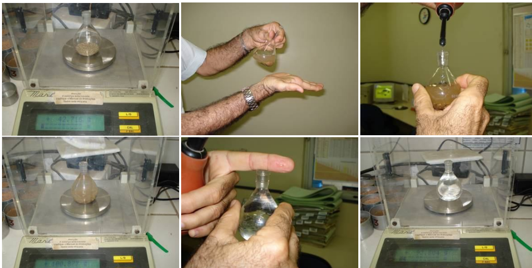
Figura 5.12: Ilustração dos procedimentos do ensaio de densidade real modificada (Fotos do autor).
