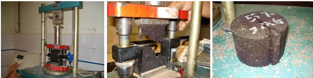
Figura 2.79: Rompimento de corpo de prova no ensaio de resistência à tração por compressão diametral (Fotos do autor).
