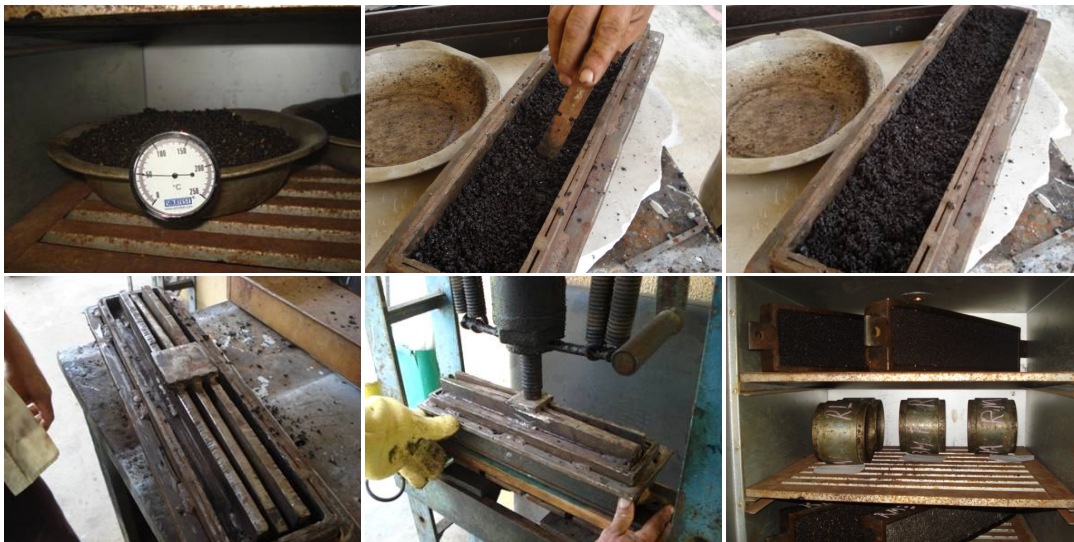
Figura 6.26: Procedimentos adotados para preparação dos corpos de prova de mistura a frio para ensaio LWT (Fotos do autor).
