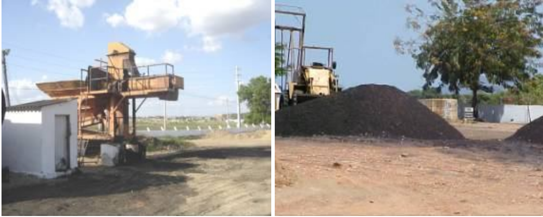
Figura 3.4: Usina de mistura a frio e massa asfáltica tipo AAUF em cura (CHAVES e MOTTA, 2005)
