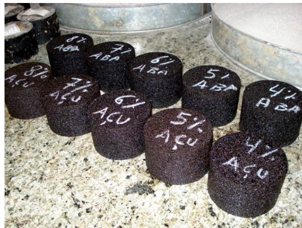
Figura 5.41: CPs moldados no compactador giratório com ligante do tipo RL-1C (Foto do autor).
