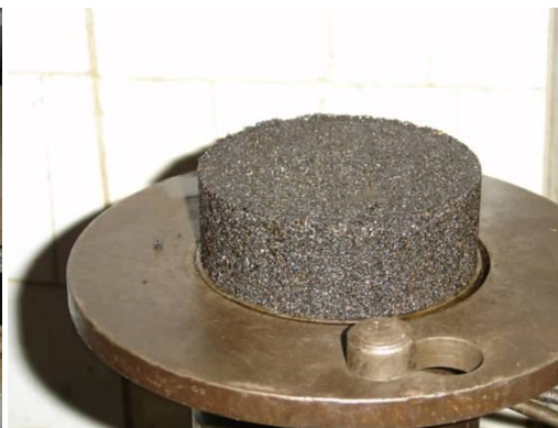
Figura 5.35: Corpo de prova de areia grossa asfáltica a quente, moldado no compactador Giratório (Foto do autor).
