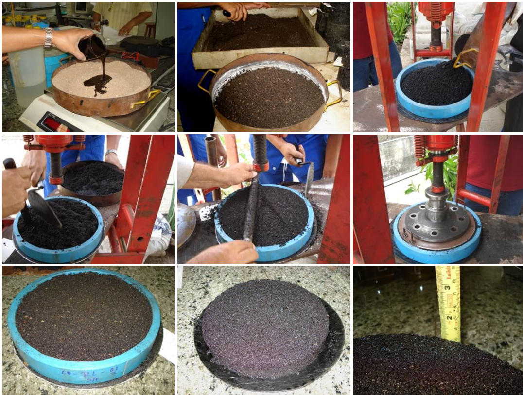
Figura 6.20: Preparação do corpo de prova de AAUF para ensaio de WTAT (Fotos do autor).
