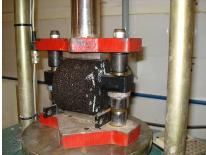
Figura 2.78: Dispositivo para posicionamento do corpo de prova para aplicação das cargas no ensaio de resistência à tração (Foto do autor).
