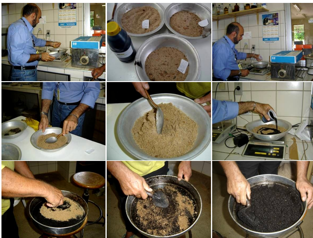
Figura 5.38: Preparação das amostras de misturas asfálticas a frio nesta pesquisa (Fotos do autor).
