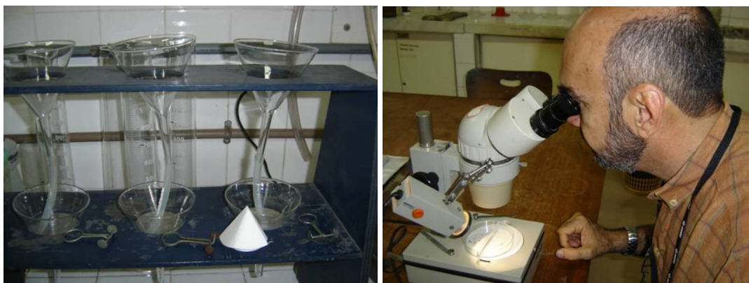
Figura 5.13: Etapas do ensaio para determinação da mineralogia das areias de rio.
