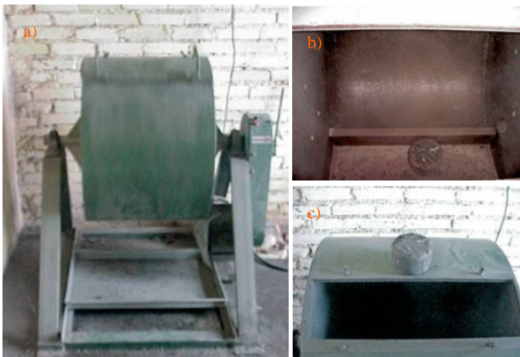
Figura 2.87: a) Máquina de abrasão Los Angeles. Nos detalhes: b) CP sem cargas abrasivas dentro do cilindro e c) CP após o ensaio (BERNUCCI, et al. , 2007).
