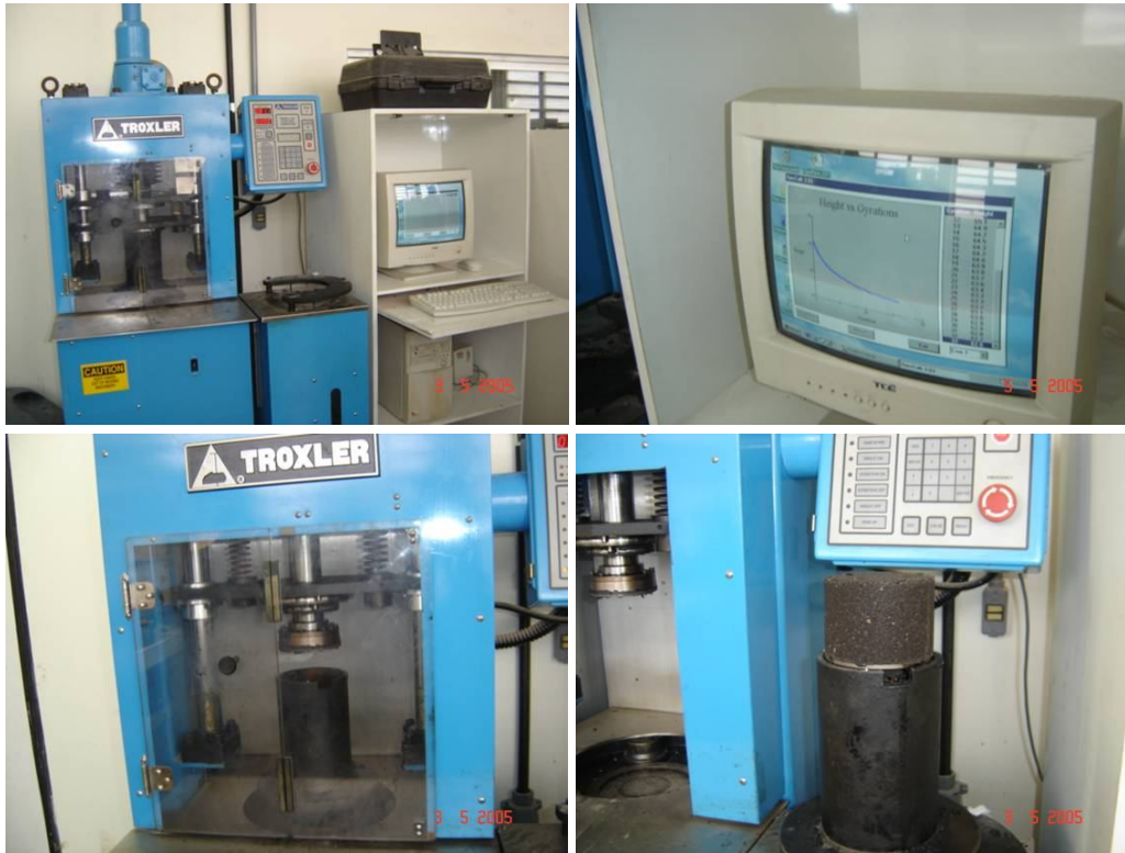
Figura 5.42: Compactador Giratório Troxler 4140 do laboratório de Mecânica dos Pavimentos/UFC utilizado nesta pesquisa (Fotos do autor).
