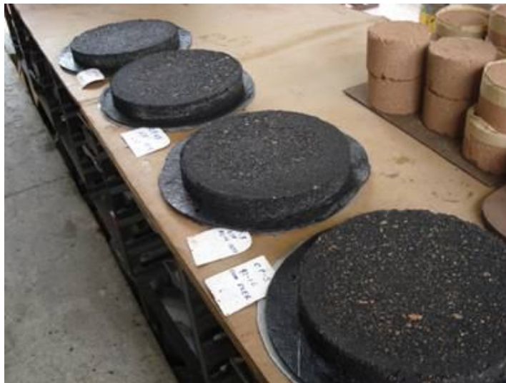
Figura 6.22: CPs secos para pesagem final (Foto do autor).
