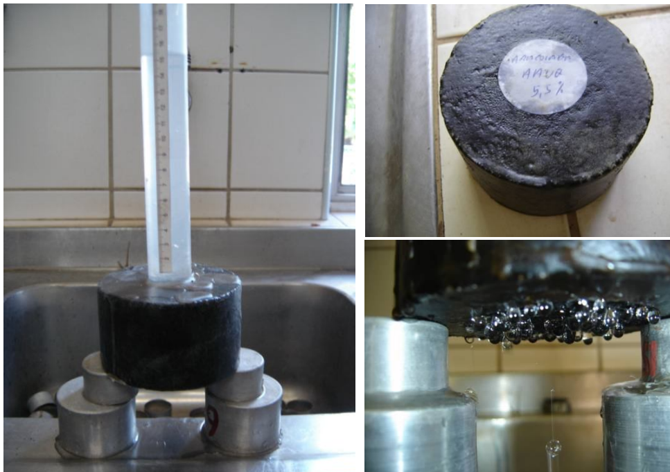
Figura 5.43: Esquema do ensaio de drenabilidade, observando-se nos detalhes o envolvimento com parafina e o escoamento da água pelo corpo de prova (Fotos do autor).
