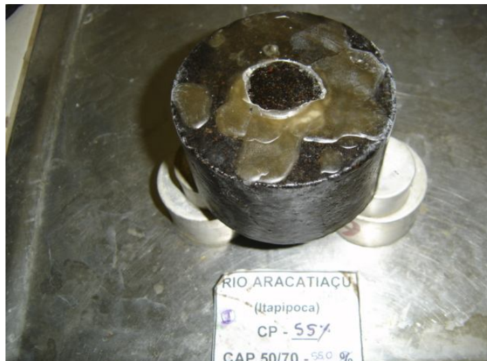
Figura 5.45: CP mostrando a área onde foi colocada água para teste de infiltração (Foto do autor).
