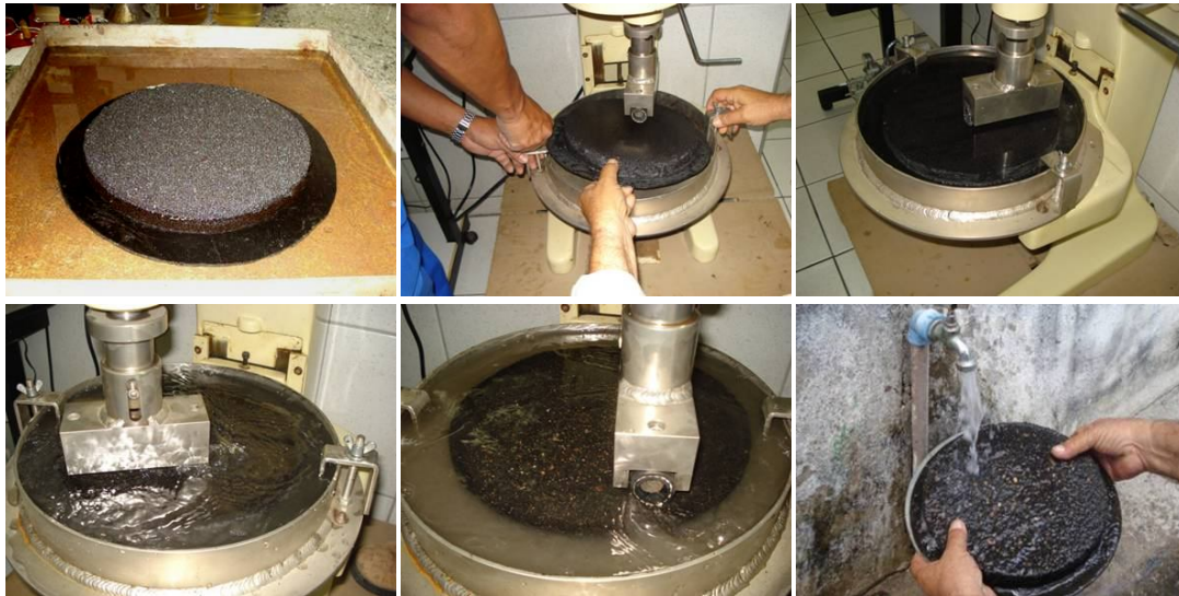
Figura 6.21: Ensaio de WTAT em corpos de prova de misturas asfálticas a frio (Fotos do autor).
