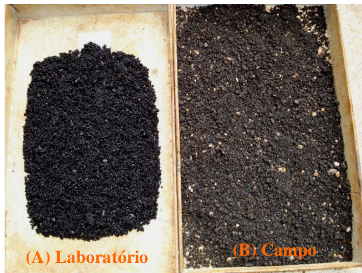
Figura 5.65: Aspectos das misturas a frio com areia do rio Aracoiaba, realizadas em laboratório (A) e em usina no campo (B) (Fotos do autor).
