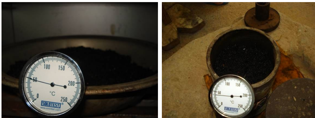
Figura 5.53: Temperatura de cura da mistura solta (50°C) e de compactação (40°C) (Fotos do autor).
