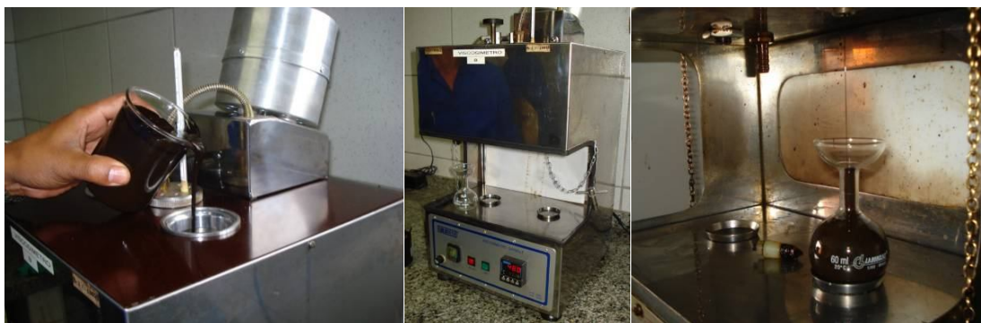
Figura 2.67: Ensaio no viscosímetro Saybolt-Furol (Fotos do autor).
