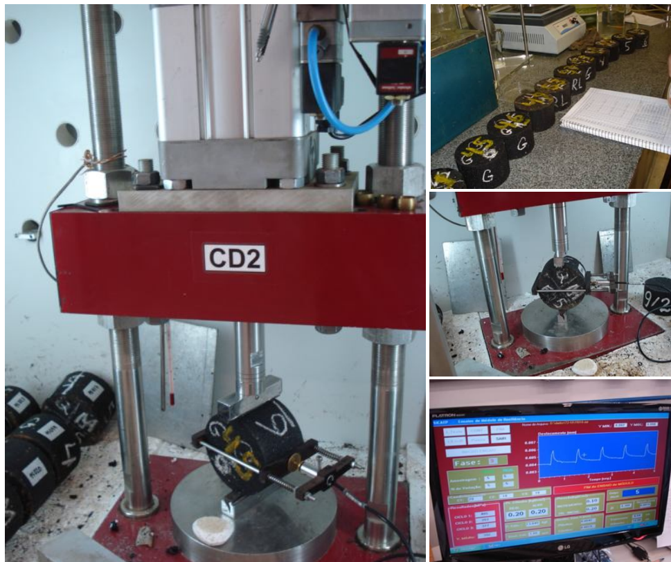
Figura 6.16: Ensaio de módulo de resiliência em misturas do tipo areia asfáltica a frio na COPPE/UFRJ (Fotos do autor).
