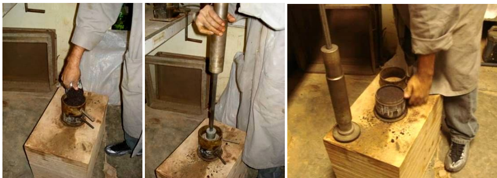
Figura 5.37: Compactação manual do tipo Marshall (Fotos do autor).
