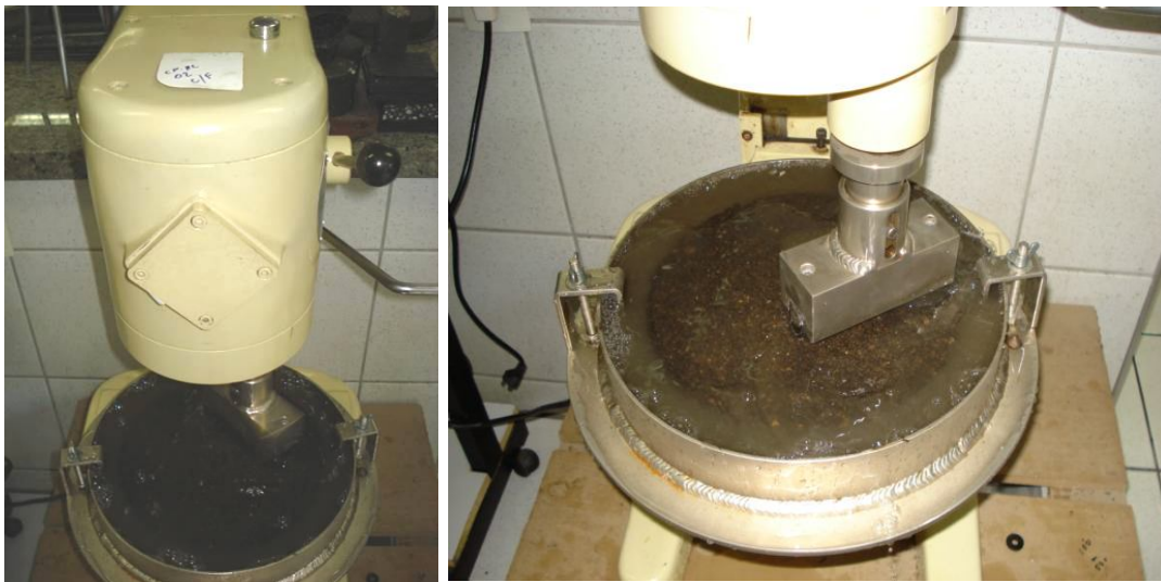
Figura 2.89: Aparelho para ensaio de WTAT e no detalhe a borracha para abrasão (Fotos do autor).
