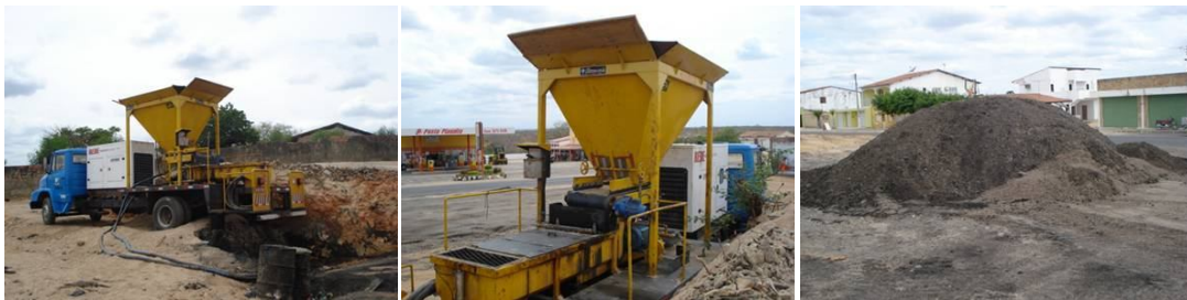
Figura 3.10: Usina móvel de mistura a frio com a massa asfáltica em cura (Fotos do autor).
