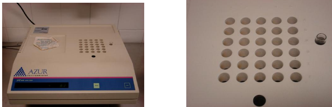
Figura 15 – Vista do luminômetro (a) e suporte para cubetas (b) utilizado nos ensaios de toxicidade
