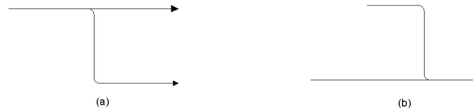
Figura 1: Flechas ramificadas. (a) Flecha com ramificações divergentes. (b) Flecha com ramificações convergentes.
