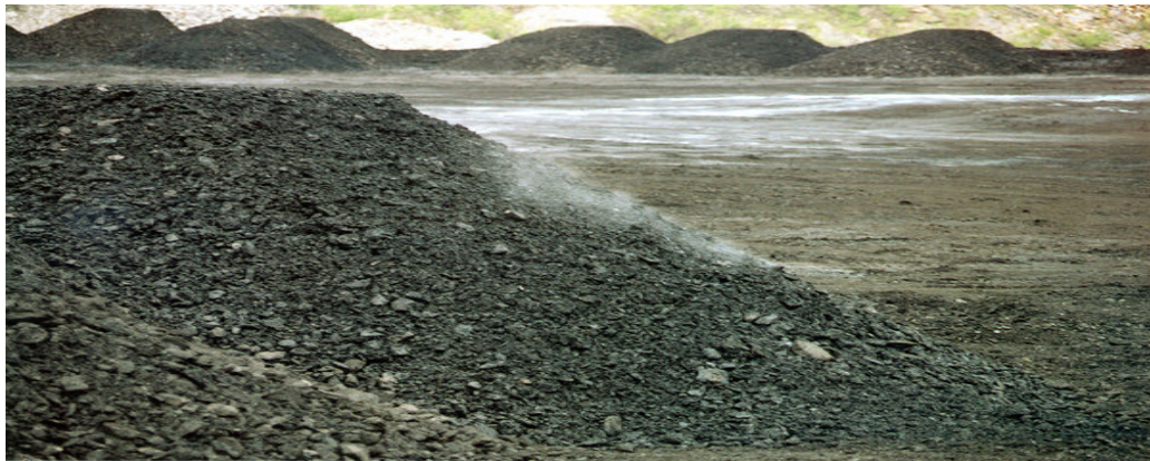
Figura 9. Foto dos montículos de xisto retortado que são dispostos no pátio até atingir a temperatura ambiente, liberando vapor d'água e gases para a atmosfera (fonte Hélivio Rech)
