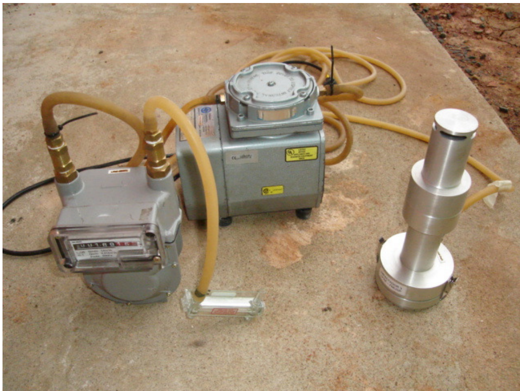
Figura 16. Foto do impactador Harvard (bomba de sucção do ar e coletor) utilizado na coleta de \text{PM}_{2,5}
