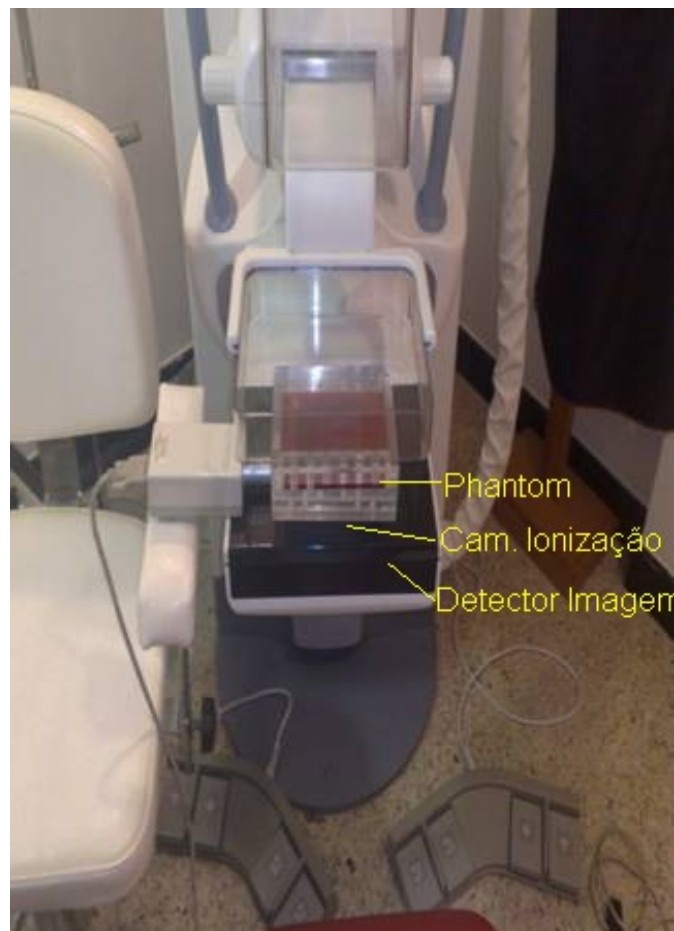
Figura 4.6: Posicionamento da câmara de ionização abaixo do phantom
