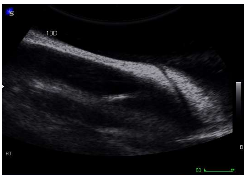
Figura 4.33 – Imagem ultrassonográfica da hemimandíbula 10D, realizada com transdutor convexo depois da osteotomia, mostrando imagem hiperecótica, correspondente ao artefato metálico
