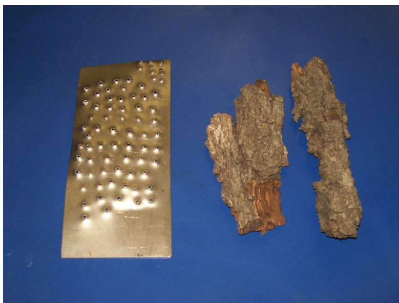
Figura 9 - Fotografia do ralador de titânio e amostras de casca de árvore
