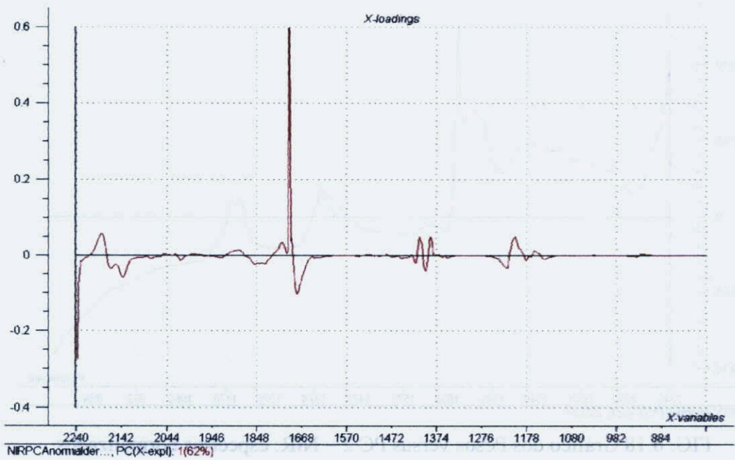
FIG. 6.20 Gráfico dos Pesos versus PC 1 – NIR: espectros normalizados e derivados
