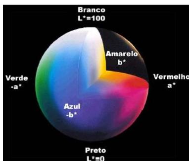
Figura 21- Esquema CIElab\*.
