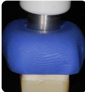
**Figura 23** – Leitura da cor com espectrofotômetro (Easyshade).
