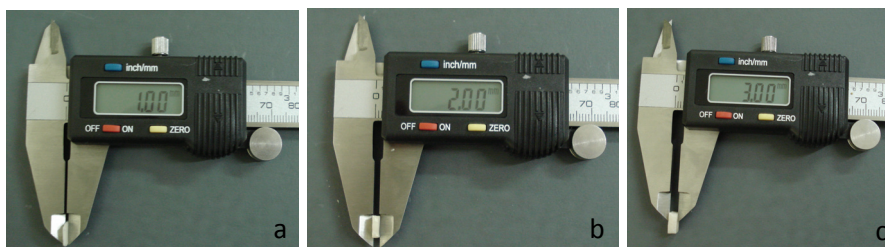
FIGURA 7 - Bloco cerâmico após fundição, acabamento e polimento, nas 3 medidas: a)1mm; b) 2mm e c) 3mm.
