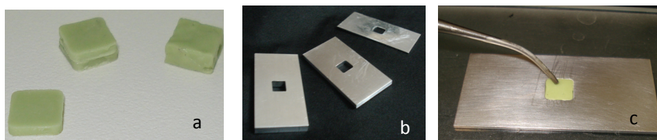
FIGURA 3 – Confeção do padrão de cera para fundição da cerâmica: a) padrões de cera nas 3 espessuras diferentes.; b) matriz de alumínio; c) encheramento dos padrões de cera.
