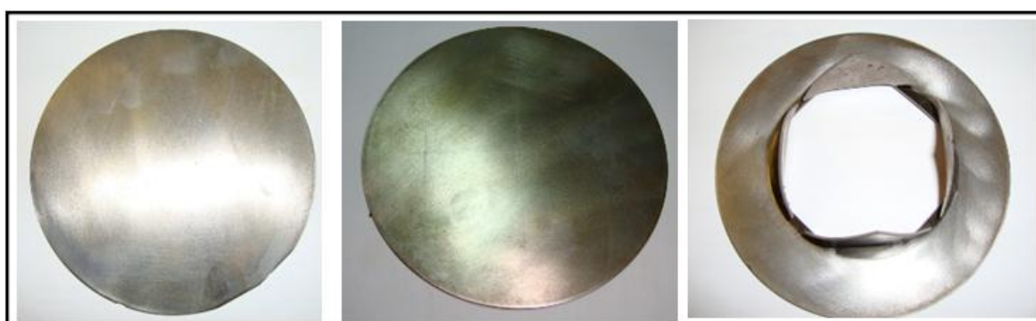
Figura 75: Sequência do processo de confecção e ensaio do diafragma para teste no Túnel de Vento Hipersônico T1.
