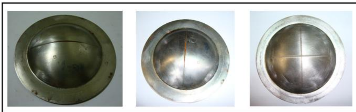
Figura 69: Teste de fratura feito no pistão com diafragmas.
