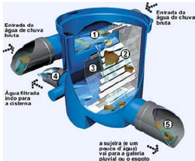
Figura 15: Filtro VF1 para coleta e aproveitamento da água de chuva Fonte: 3P Technik (2009)
