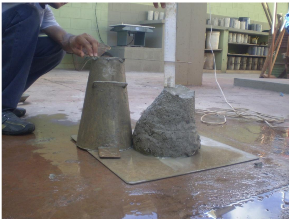
Figura 4-3-1: Ensaio de tronco de cone. Determinação do abatimento.
