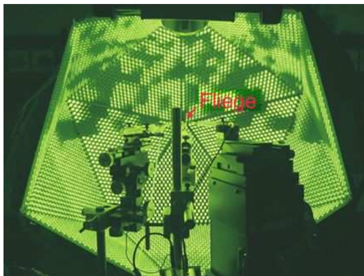
Figura 5 – Gerador de estímulos visuais FliMax
