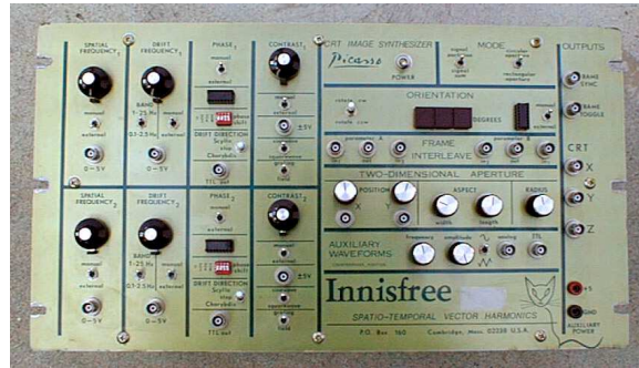
Figura 1 – Gerador de estímulos visuais Picasso
