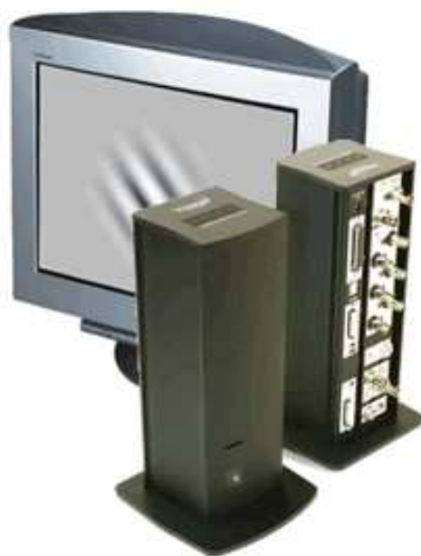
Figura 3 – Gerador de estímulos visuais ViSaGe (16)
