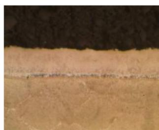
Após teste de oxidação 47h
