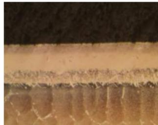
Figura 46. Amostras após testes de oxidação para avaliação metalográfica com aumento de 400 vezes.
