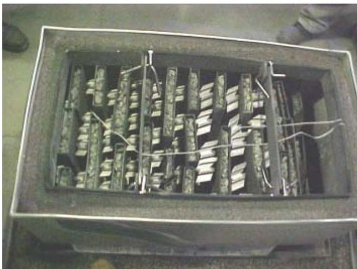
Figura 41. Cestas perfuradas para preenchimento com Palhetas de turbina de baixa pressão (LPT Blade) de motor CF6-50.
