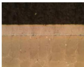
Após teste de oxidação 23h
