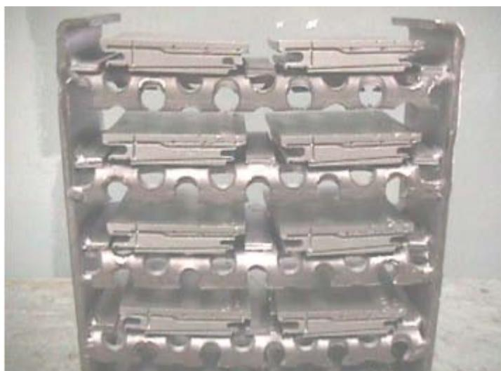
Figura 42. Cestas perfuradas para preenchimento com capas de palhetas de turbinas de alta pressão (HPT Shroud) de motores CF6-80 C2.
