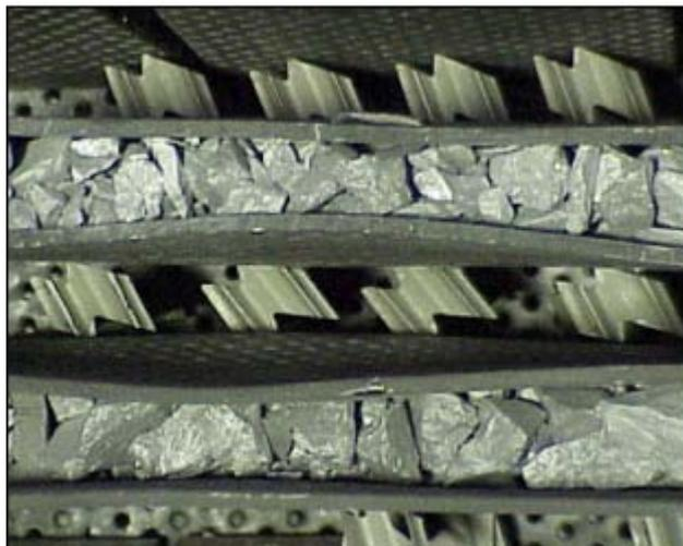
Figura 43. Cestas perfuradas para preenchimento com palhetas de turbinas de baixa pressão (LPT blade) de motor CFM56-3.
