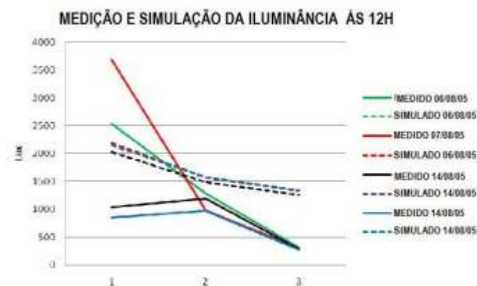
Figura 23: Comparação da iluminância medida e simulada em sala em Belo Horizonte no EnergyPlus .
