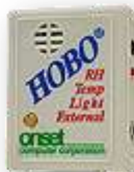
Figura 29: HOBO - Datalogger utilizado para a medição de iluminância no edifício monitorado.
