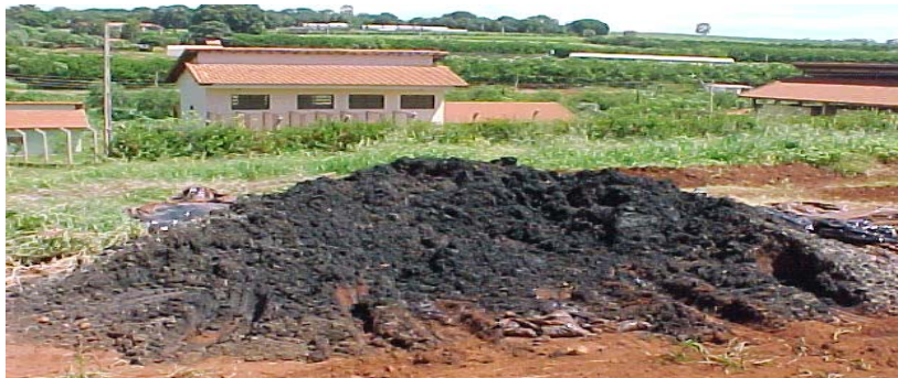
FIGURA 1.5 - Lodo de esgoto coletado na Estação de Tratamento de Esgoto da SABESP localizada em Barueri-SP.
