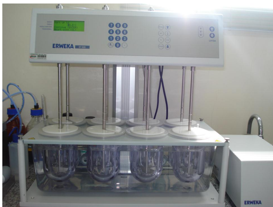
Figura 15 – Fotografia do equipamento de dissolução Fonte: Foto da autora
