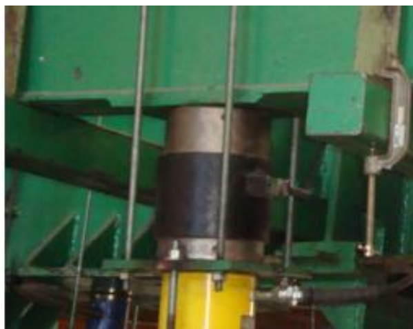
Figura 3.37 – Célula de carga empregada na aplicação de carga.
