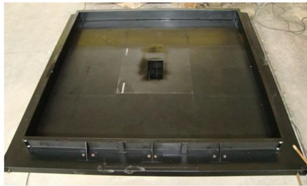
Figura 3.18 – Fôrma pronta para receber a armadura.
