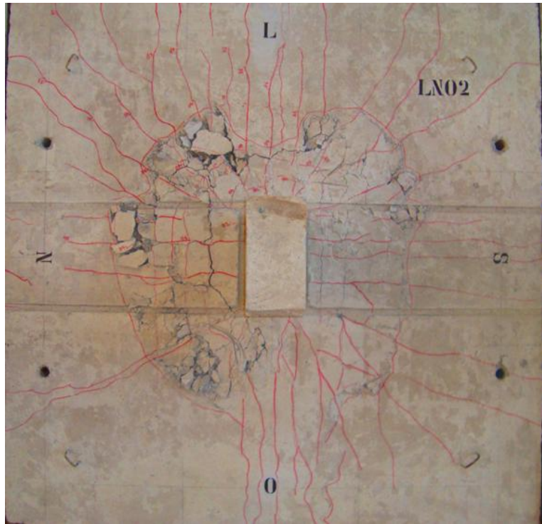
Figura 4.74 – Padrão de fissuração do modelo LN02.
