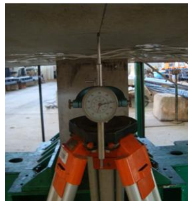
(d) Deflectômetros posicionados na face inferior
