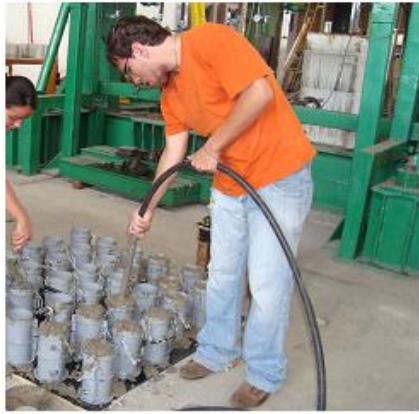
(a) Vibrador de imersão.
