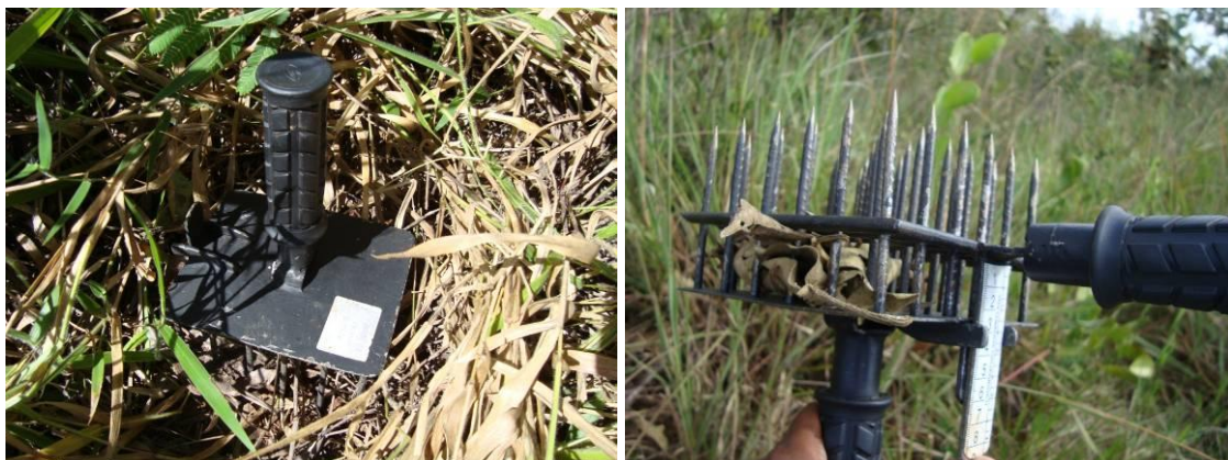
Figura 6. Instrumento medidor da espessura (em cm) da camada de serapilheira.
