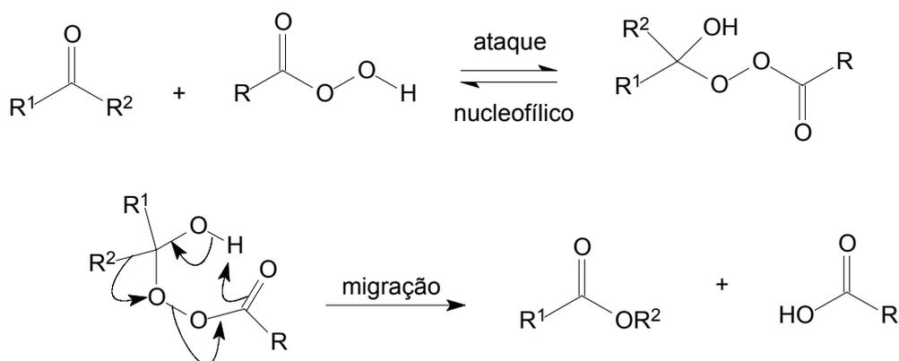
FIGURA 4.121 – Mecanismo de reação de oxidação de Baeyer-Villiger.
