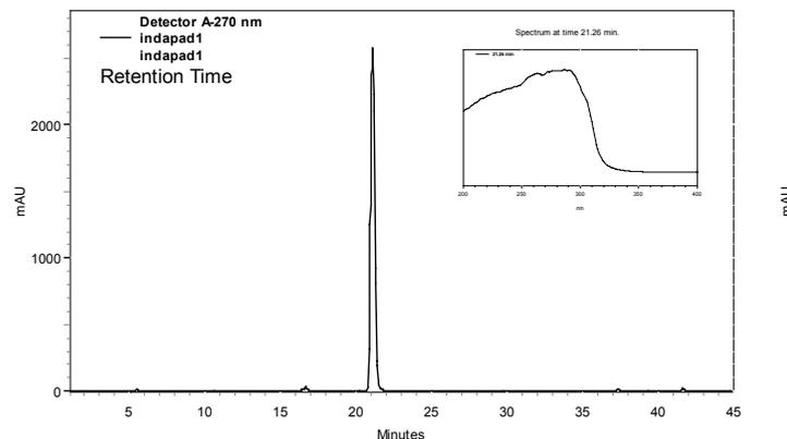
FIGURA 4.89 – Cromatograma do substrato 1-indanona com seu respectivo espectro de UV.
