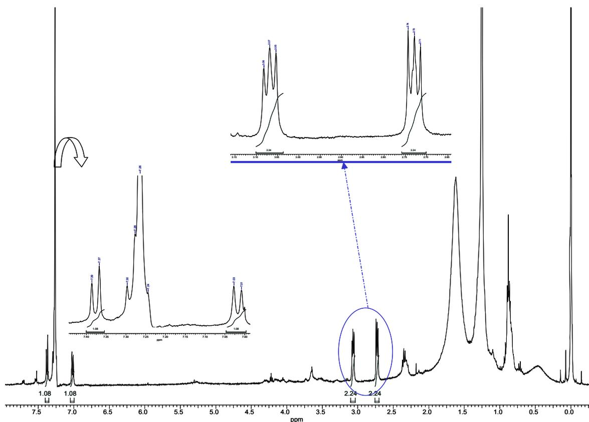
FIGURA 4.74 – Espectro de hidrogênio da amostra biotransformada (400MHz -  $\text{CDCl}_3$ ).
