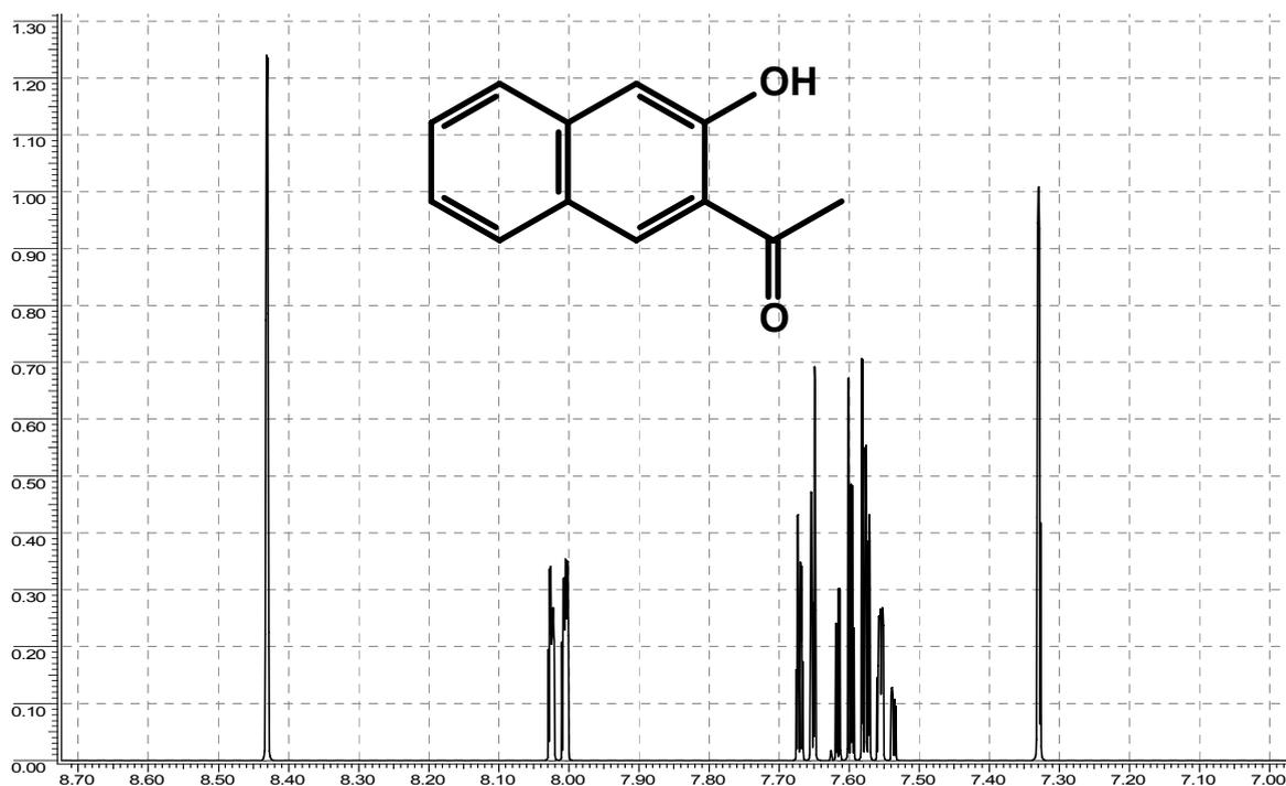
FIGURA 4.138 – Espectro simulado para a estrutura proposta indicada.
