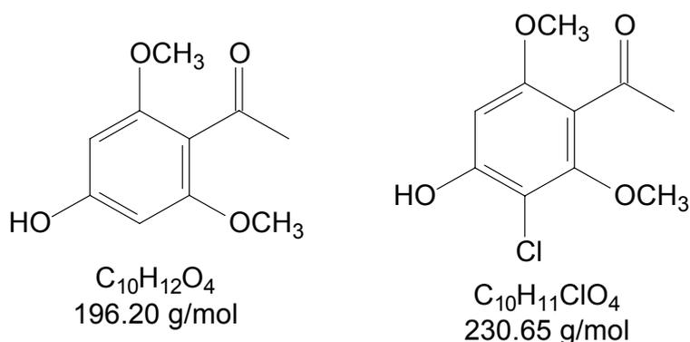
FIGURA 4.66 – Produtos biotransformados: 4'-hidroxi-2',6'-dimetoxiacetofenona e 3'-cloro-4'-hidroxi-2',6'-dimetoxiacetofenona.
