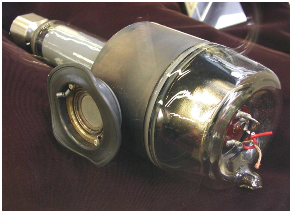
Figura 10: Tubo de raios X (FREITAS, 2004).
