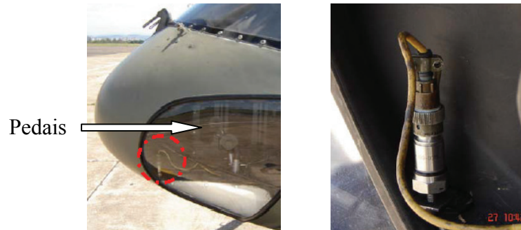
Figura 8 – Posicionamento do acelerômetro na cabine [14]
