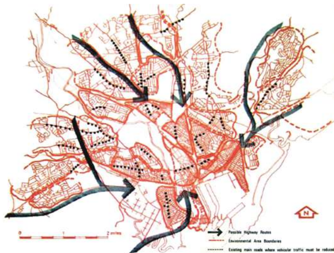
Figura 50: Cardiff: Development and Transport Study, Colin Buchanan&Partners, 1966 – identificação das environmental areas e estabelecimento de diretrizes para sistema viário estrutural
