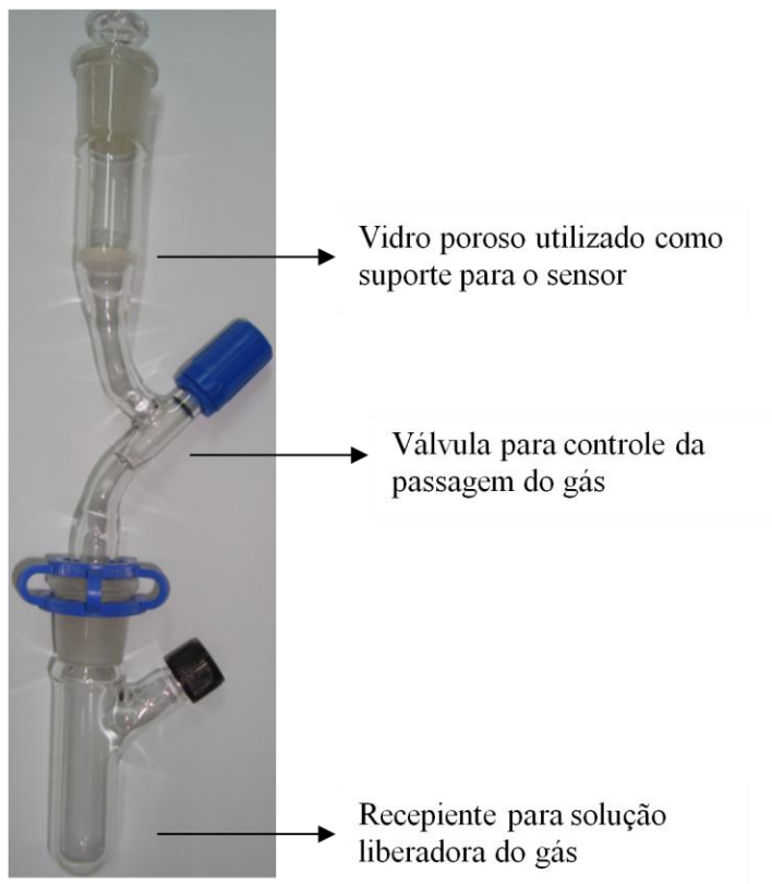
Figura 3.1: Vidraria desenvolvida para a coleta do tempo de resposta ao gás amônia dos sensores.
