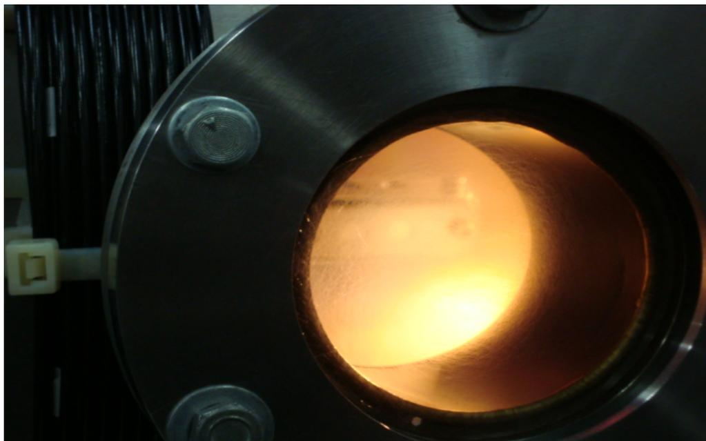
**Figura 3.7** Câmara durante o processo IIP na primeira etapa de tratamento (Cortesia INPE/LAP).
