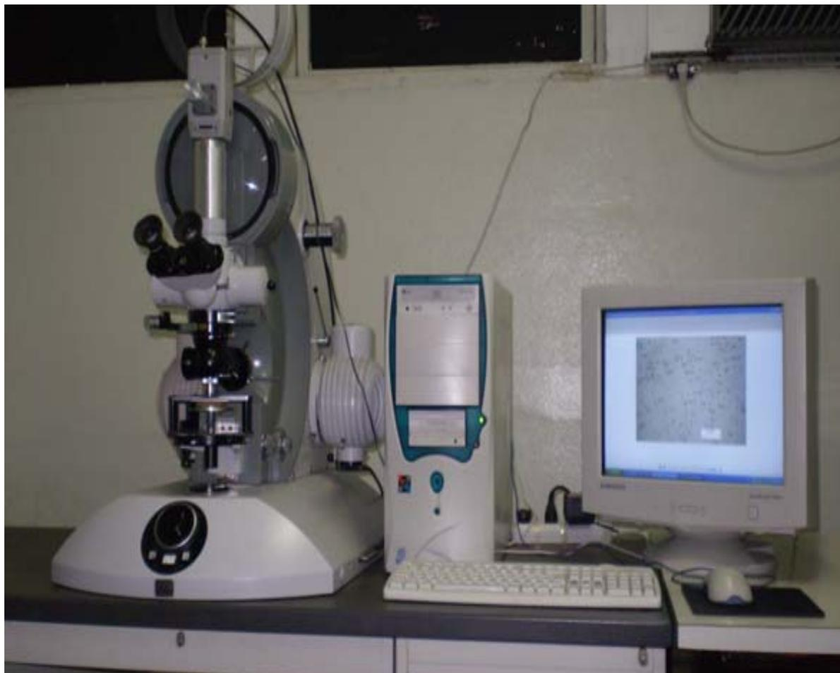
**Figura 3.10** Microscópio Óptico da Marca Carl Zeiss com aquisição de imagens do Laboratório de Microscopia do Instituto Tecnológico de Aeronáutica.
