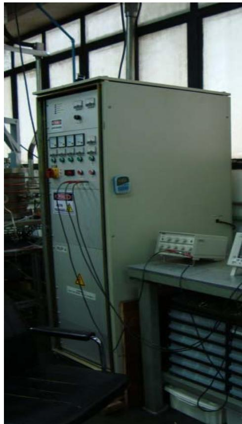
**Figura 3.5 Foto do pulsador de alta tensão RUP-4 (Cortesia INPE/LAP).**
