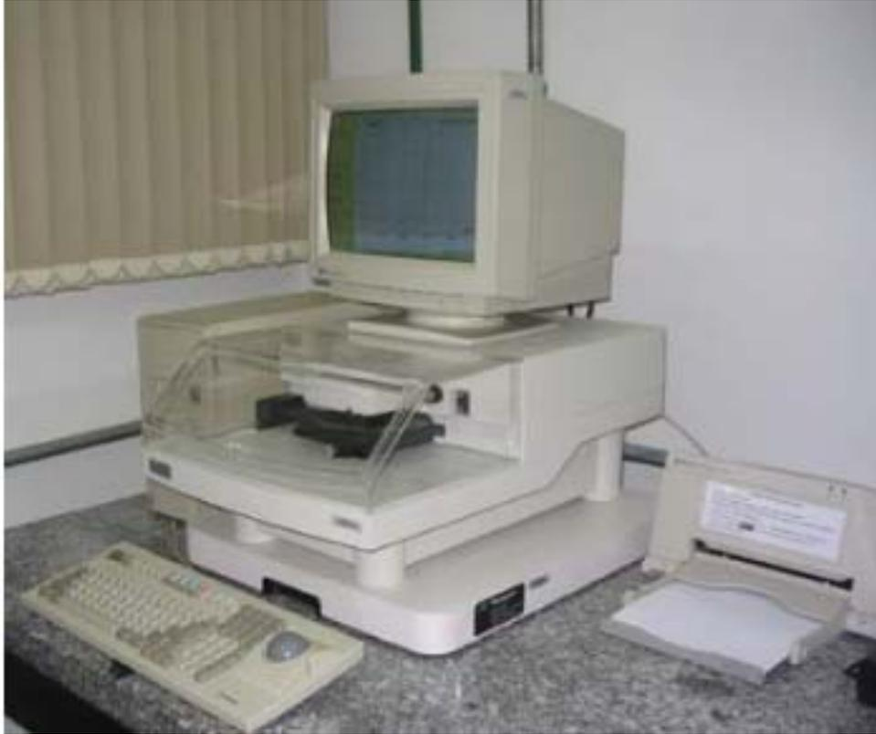
**Figura 3.12** Perfilômetro Alpha-Step 500 da Tencor [32].
