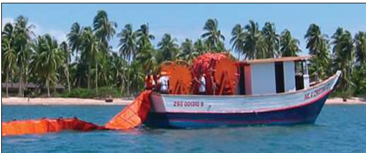
Figura 40 – Lançamento de barreiras de contenção
