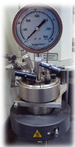
Figura 37. Reator Parr com volume interno de 50 mL.
