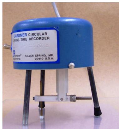
Figura 7.3: Equipamento para a determinação de tempo de secagem.
