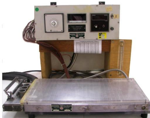
Figura 7.2: Equipamento para a determinação da TMFF.
