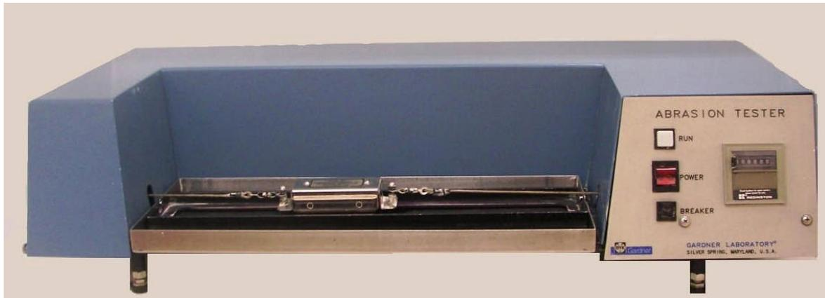
Figura 7.1: Equipamento para a determinação de resistência à abrasão úmida.
