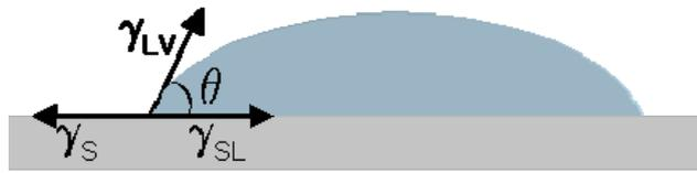
Figura 4.12. Ilustração do ângulo de contato  $\theta$  entre uma gota líquida e uma superfície plana e horizontal. Nesta figura,  $\gamma_S$  e  $\gamma_{LV}$  são a energia de superfície do sólido e a tensão superficial do líquido em equilíbrio com o vapor, respectivamente;  $\gamma_{SL}$  é a energia da interface sólido-líquido (Adamson, 1990).
