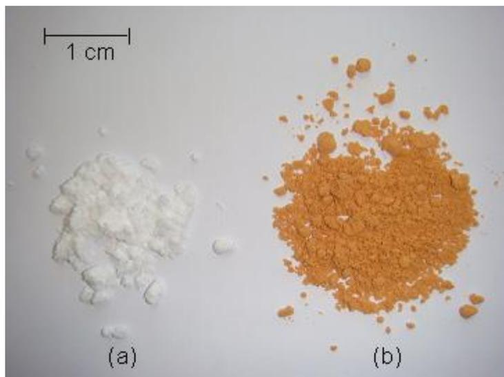
Figura 5.36– Aspecto físico das partículas híbridas obtidas da secagem das suspensões por *spray-drying*: (a) ausente de carga de fármaco e (b) e com carga de fármaco.
