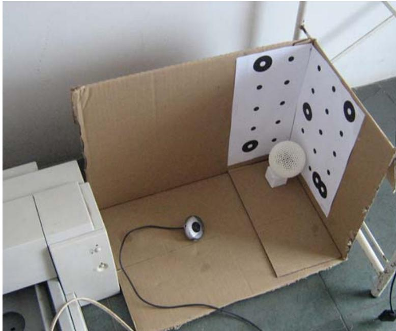
Fig. 62 – Escaner 3D caseiro de baixo custo feito com um laser de diodo e uma webcam. O software pode ser obtido no site <http://www.david-laserscanner.com/> (acessado dia 01.01.2010)
