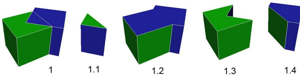
Fig. 50 – Exemplo de modelagem por operação booleana. A imagem da esquerda (1) representa dois cubos que se penetram. 1.1 representa a área de intersecção dos cubos. Em 1.2 foi aplicada a operação de união, só existe um objeto agora. 1.3 mostra o resultado da subtração do cubo azul no cubo verde e 1.4 a subtração do cubo verde no cubo azul.
