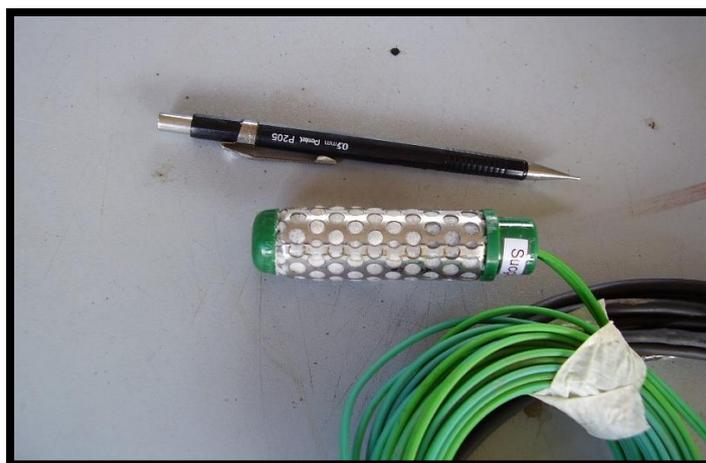
Figura 3.7: Sensor de sucção (GMS)
