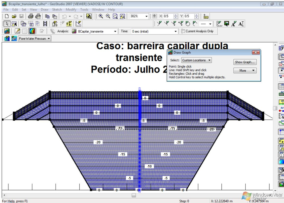
Localização dos pontos de medição de umidade e poropressão para o caso 2
