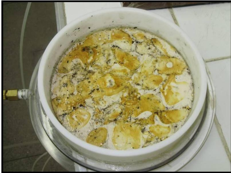
Figura 4.10: Precipitação de ferro oriundo do rejeito grosso
