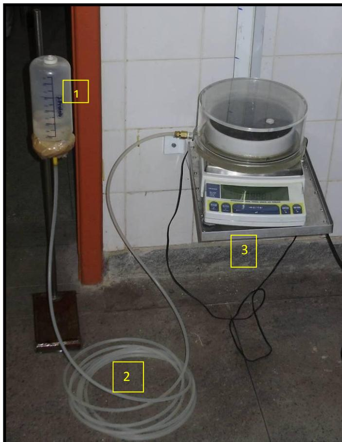
Figura 4.7: Acessórios necessários para o ensaio. 1) Reservatório de água; 2) mangueira e 3) Conjunto Placa de sucção + balança semi-analítica.
