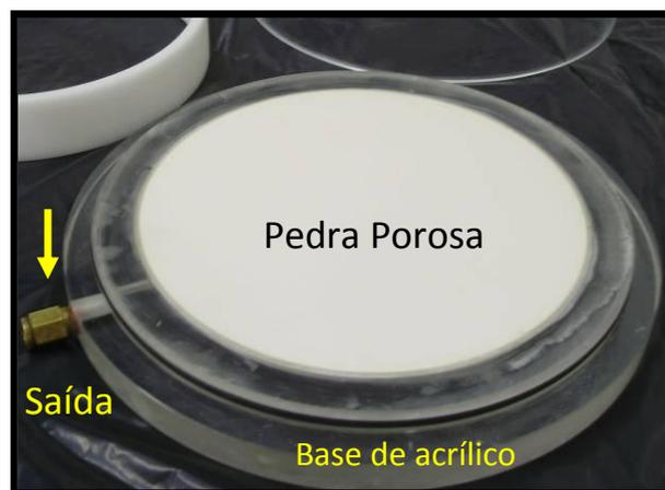
Figura 4.3: Base da placa de sucção
