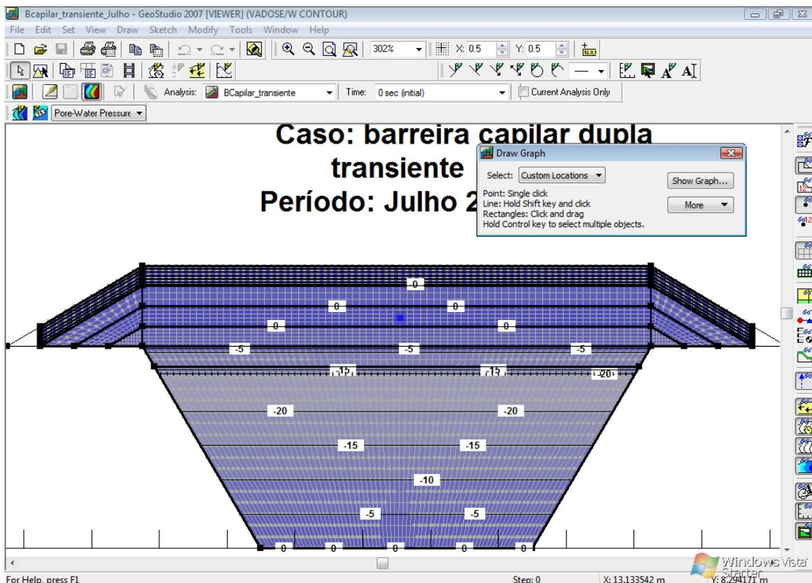
Localização do ponto de medição da saturação da camada argilosa
