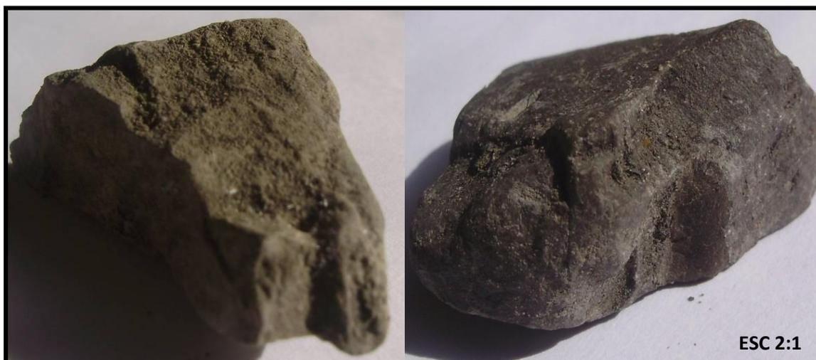
Figura 5.3: Foto com zoom macro do rejeito grosso após lavagem e secagem ao ar.
