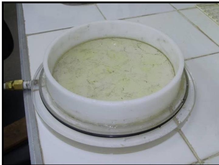
Figura 4.11: Pedra porosa com ácido oxálico 10% após alguns minutos
