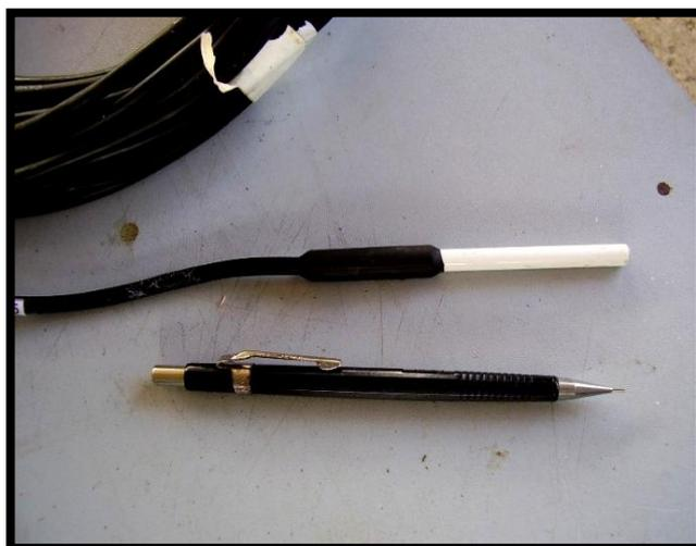
Figura 3.8: Sensor de temperatura
