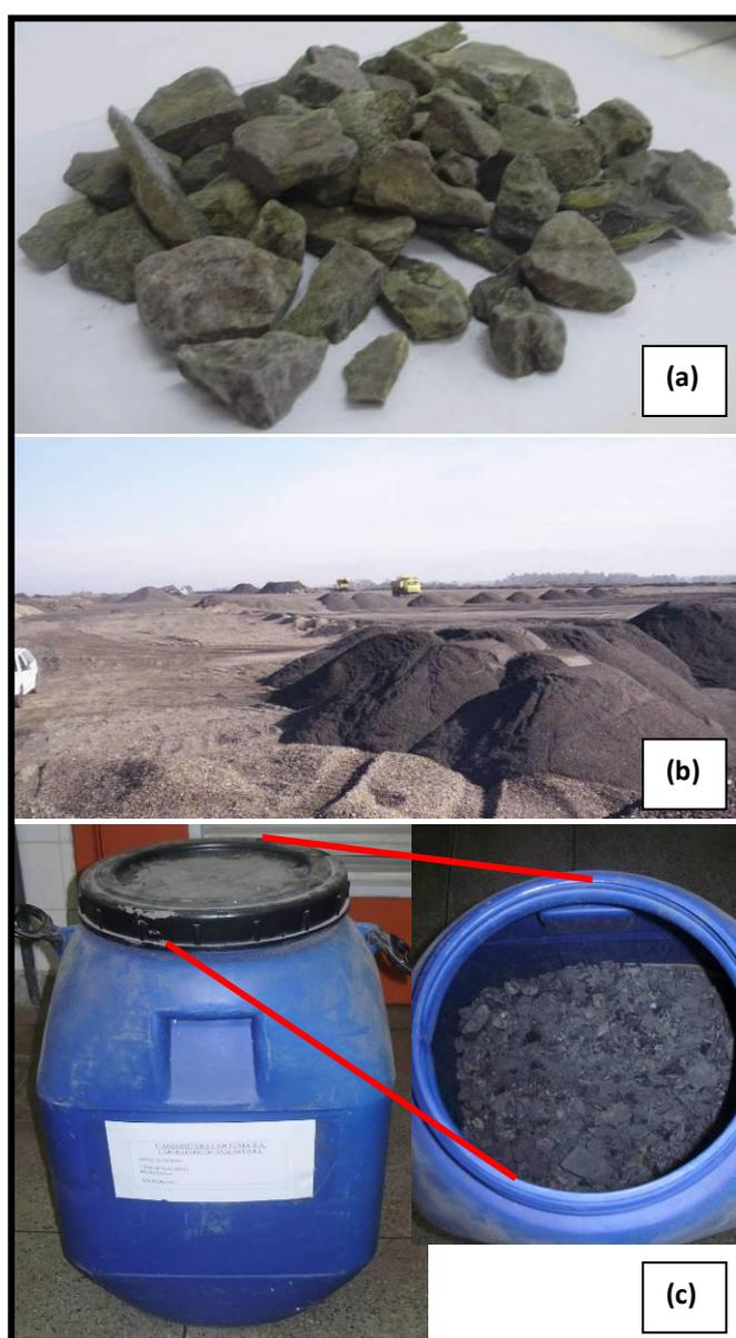
Figura 4.2: Material utilizado no ensaio. (a) rejeito grosso; (b) pilha de deposição dos rejeitos; (c) acondicionamento da amostra em bombona sem água.
