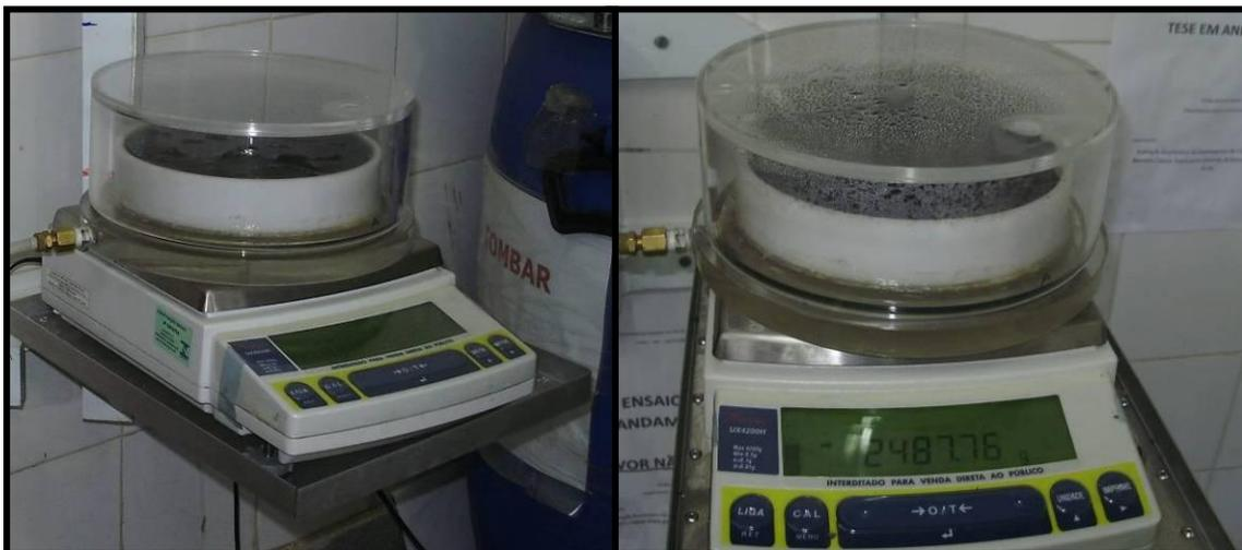
Figura 4.6: Balança semi-analítica utilizada no ensaio da placa de sucção.
