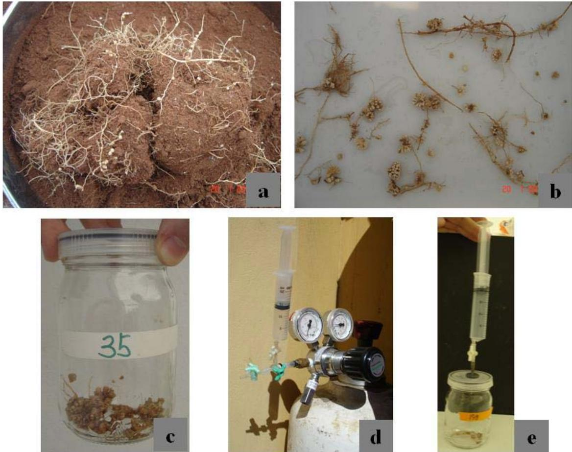
Figura 9 – Atividade da redução do acetileno. Coleta dos nódulos nos vasos (a); separação dos nódulos (b); incubação (c) com gás acetileno (d) e (e)
