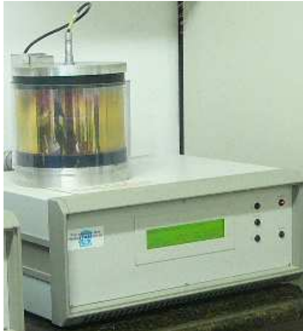
Figura 3.15: Sputtering utilizado na deposição do filme fino de ouro.
